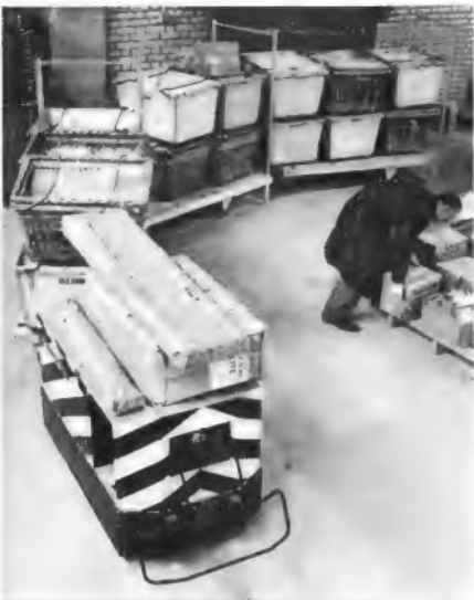
Bild 12. Der automatisch fahrende Robotug-Lastzug im Lager eines Warenhauses
