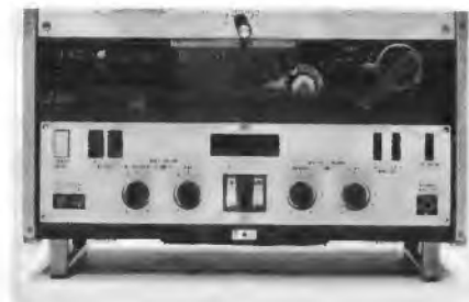
Bild 3. Die Bedienungsplatte des größten Sony-Tonbandgerätes TC-600. Dieses Gerät ist speziell für senkrechten Betrieb gebaut, was z. B. in Amerika sehr beliebt ist
