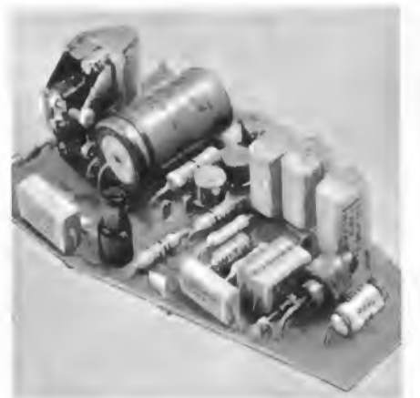
Bild 3. Die Leiterplatte des Schaltgerätes besteht aus Glasfaser-Epoxydharz. Die vergoldeten Tastenkontakte sind in die gedruckte Schaltung einbezogen
