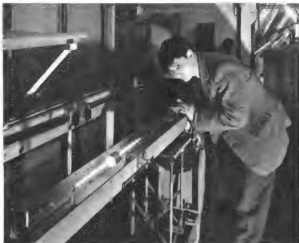
Bild 8. Anordnung zur Untersuchung der Laserstrahl-Führung in Rohrleitungen mit Schutzgasatmosphäre. Vorn links der Gas-Laser, rechts oben der Anfang der Rohrleitung (Standard Electric Laboratories)
