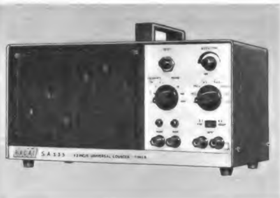
Rechts: Bild 7. Transistorisierter, tragbarer Frequenzmesser mit digitaler Anzeige bis 1,2 MHz, zugleich Intervallzähler für den Bereich 1 Mikrosekunde bis 10 4 Sekunden mit einer Genauigkeit von \pm 1 \mu\text{sek} (Modell SA 535 von Racal)
