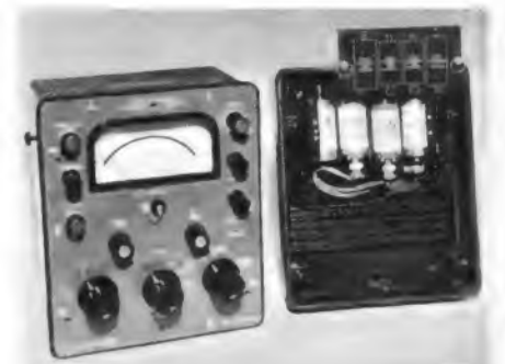
Bild 2. Transistorisiertes Vielfachmeßgerät (Gleich- und Wechselspannungen bzw. -ströme, obere Frequenzgrenze 2 GHz), Modell CT 471 B von Bradley
