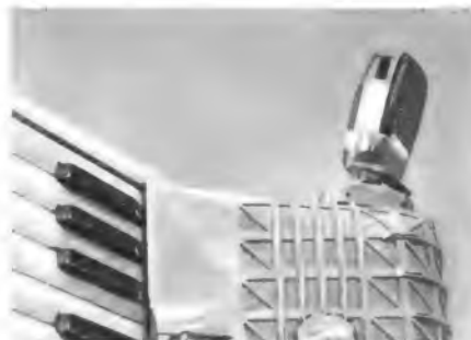
Bild 3. Mikrofon mit einem Brücken-Haftfuß auf dem Akkordeon befestigt
