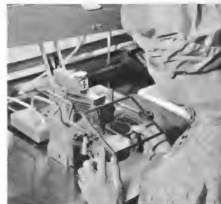
Bild 10. Eine diffizile Arbeit: das Aufziehen und Punktschweißen der hauchdünnen durchsichtigen Metall-Elektroden eines EMI-Orthikons
