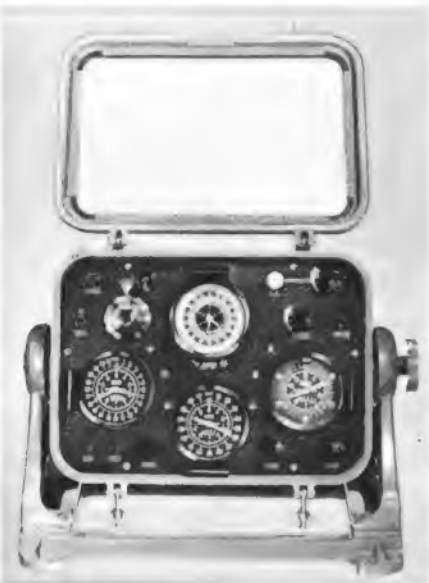
Bild 13. Der Decca-Navigator; nach dem erstmaligen Justieren am Abgangshafen geben die Instrumente laufend selbstständig die Werte für die Schiffsposition nach einem Spezial-Kartennetz an
