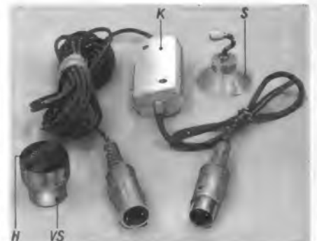
Bild 6. Das für die Musterausführung mit einem Peiker-Mikrofon TM 24 verwendete Zubehör: VS = Zwischenstück mit Haftschale, S = Haftsauger, K = Kabelübertrager, H = Haftschale
