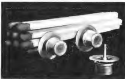
Bild 4. Wie Baumstämme wirken die Streichhölzer im Vergleich zu dem Siemens-Germanium-Mesa-Transistor AFY 34 mit koaxialem Metallgehäuse. Der Transistor schwingt bis etwa 3,5 GHz
