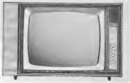
Bild 8. Tischempfänger Ariadne von Loewe-Opta mit symmetrischer Frontaufteilung. Bei Nichtgebrauch kann eine abschließbare Jalousie Bildfeld und Bedienungsteil abdecken
