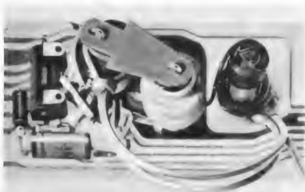
Bild 6. Schaltplatte mit Zeilenablenkteil von Graetz. Die Anschlüsse sind steckbar, die Fassung der Hochspannungsdiode ist leicht auswechselbar
