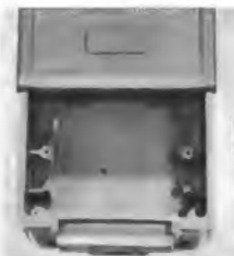
Bild 6. AKW 800, universelle Weiche zum Zusammenschalten zweier UHF-Antennen (Fuba)
