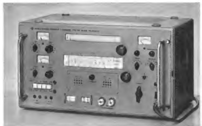
Bild 9. Großes Transistor-Meßgerät TYM von Rohde & Schwarz. Hiermit lassen sich die dynamischen Werte von Transistoren (y-Parameter) für Frequenzen von 500 kHz bis 30 MHz messen
