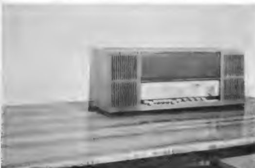
Bild 4. Luna-Stereo 52070 von Loewe-Opta. Oben: der linke Lautsprecher kann vom Ger t entfernt aufgestellt werden; unten: hier ist der linke Lautsprecher an das Ger t heranger ckt
