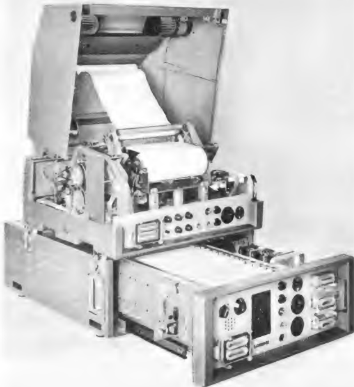
Bild 2. Schnellfern-schreibempfänger LO 2000 (geöffnet) mit elektronischem Empfangsgerät (Standard Elektrik Lorenz)
