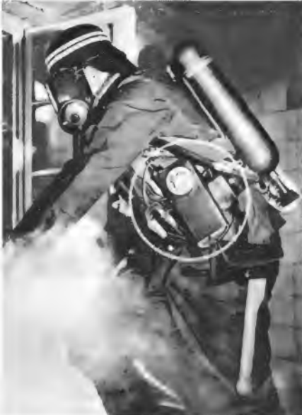
Bild 4. Im Kreis: Notsignalgeber für Feuerwehr- und Rettungsleute. Ein- bis zweimal pro Minute muß der Träger den Geber durch einen Ellenbogenstoß „beruhigen“, anderenfalls stößt er gellende Hilfesignale aus
