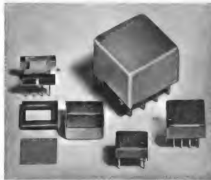
Bild 5. Einzelteile der Ferroxcube-H-Kerne (Valvo)
