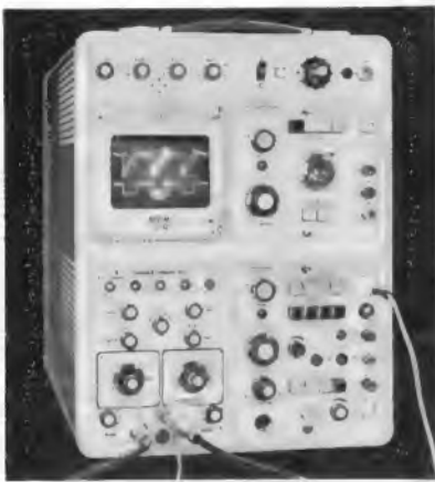
Bild 4. Siemens-Hochleistungs-Oszillograf Typ Oscillar 1/G 60; Verstärker und Ablenkergeräte sind als Einschübe ausgebildet
