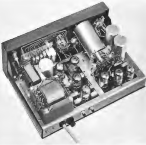
Links: Bild 3. Der Blick auf die Oberseite des Chassis läßt den gedrängten Aufbau im Flachgehäuse erkennen. An der Rückseite sind die beiden Einsteller für den horizontalen und vertikalen Bildstand zugänglich. An der Frontplatte links ist die Printplatte mit den Schaltelementen für den elfstufigen Schalter der Zeitablenkung angeordnet
