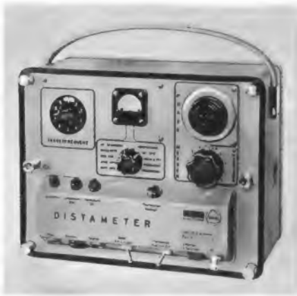
Bild 13. Distameter für die rasche Entfernungsmessung mit Hilfe von Zentimeterwellen. Maximale Reichweite: 50 km. An die rechte Seitenwand wird ein Stielstrahler für die Messung kürzerer Entfernungen oder ein 35-cm-Parabolspiegel für größere Entfernungen eingesteckt (Grundig)
