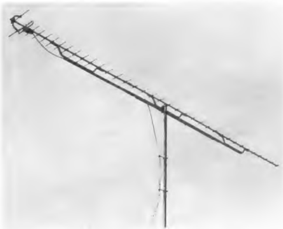
Bild 10. UHF-Kanalgruppenantenne AU 04 mit 37 Elementen (Zehnder)
