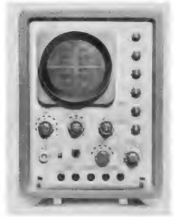
Bild 3. Philips-Oszillograf PM 3201, die Röhre besitzt ein Innenraster
