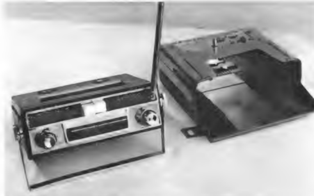
Bild 5. Zweikanal-Funksprechgerät Tokai TC 502 G mit 0,1 W an der Antenne
