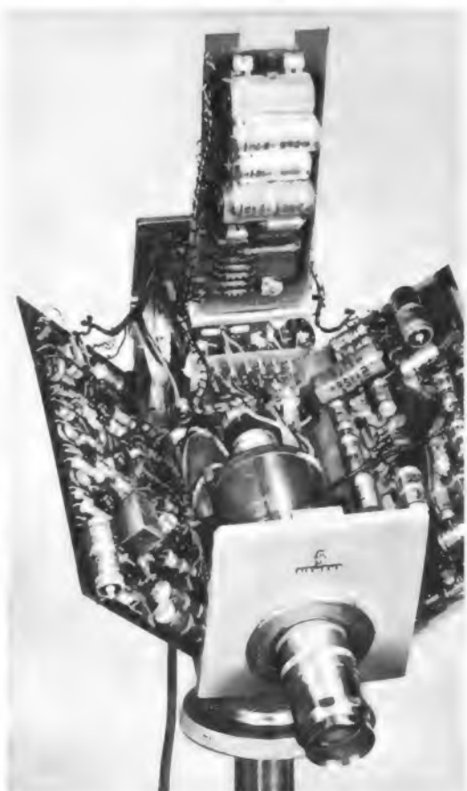
Bild 11. Siemens-Fernsehkamera in Kompaktbauweise, geöffnet. Sie enthält einen fünfstufigen Verstärker mit 1 V BA-Signal am 75-Ω-Ausgang und 5 MHz Bandbreite. Ein Hf-Senderteil für einen Kanal in Bereich I oder III kann eingesetzt werden
