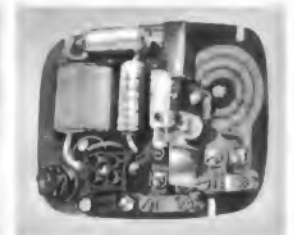
Bild 7. Kleinverstärker für Bereich V mit Subminiatur-Röhre (Kathrein)
