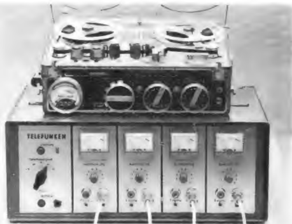
Bild 8. Magnetband-Analogspeicher MAS 54 mit vier Kanälen für Frequenzmodulation und -demodulation mit dem kommerziellen Magnetbandgerät Nogra III
