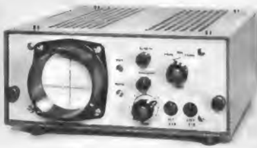
Bild 3. Kurzwellen-Panorama-Zusatz PaG 724 mit 100 kHz Abstastbereich (Telefunken)
