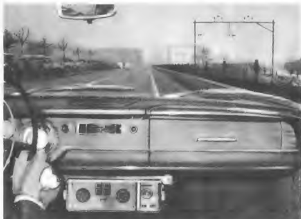
Bild 3. Besonders auf langen ermüdenden Strecken, und wenn nahegelegene Fahrdrahtleitungen den Rundfunkempfang stören, bietet das Tonbandgerät im Sabamobil angenehme Unterhaltung. Die Kassette wird einfach auf die Antriebsachsen aufgedrückt. Ein federnder Steg am rechten Rand hält sie sicher fest. Die Kassette läßt sich leicht mit einer Hand auswechseln oder wenden
