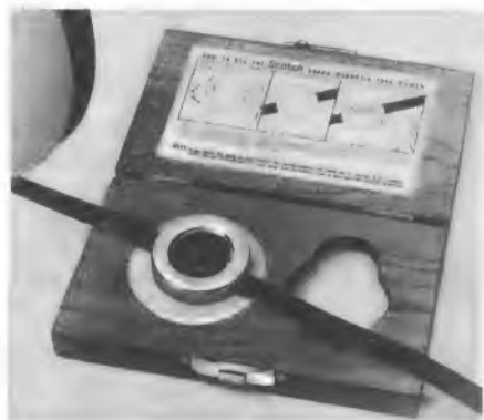
Mit Hilfe einer Magneteisendispersion im Innern des durchsichtigen Gehäuses läßt sich die Aufzeichnung eines Magnetbandes sichtbar machen
