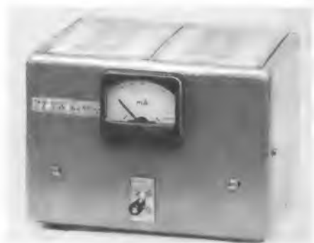
Bild 1. Der Sender TX 10 W 144 MHz im Leistnergehäuse 15. Die beiden QSL-Karten auf ihm veranschaulichen, wie klein der Sender ist
