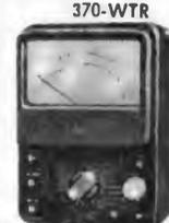
370-WTR Genauigkeit 1,5%. Frequenzbereich 0-50 000 Hz. = 20 000 Ω/V, 4 000 Ω/V. = 0,5, 2,5, 10, 50, 250, 1 000 V, 50 µA, 1, 10, 100 mA, 1 A, 10 A. ~ 2,5, 10, 50, 250, 1 000 V. ~ 0,1, 1, 10 A. dB: -20 - +10 dB, +10 - +36 dB. Ohm: Rx1, x10, x100, x1 000, x10 000. 1 Ω-50 MΩ.
