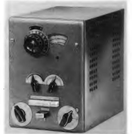
Bild 1. Ansicht des Meßsenders und Frequenzmessers in einem Breitenstein-Gehäuse
