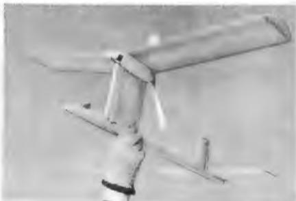
Bild 4. Elektrisch angetriebenes Flugmodell, das zur Erprobung der in Bild 2 gezeigten Zellen diente
