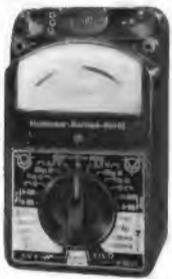
Ein Prüfgerät für Transistoren
