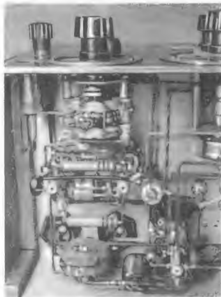
Bild 10. Verdrahtung der Endstufe
