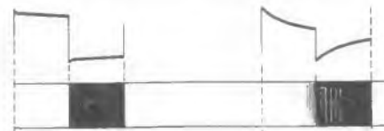
Bild 4. Oszillogramme eines Video-Verstärkers; links: exakter Schwarzweiß-Übergang bei einer Dachschräge von 2%, rechts: eine Dachschräge von 20% ergibt einen verwaschenen Übergang
