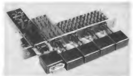
Bild 2. Der Schiebetastenschalter ist durch den eingesteckten Schlüssel entriegelt, die Taste läßt sich drücken
