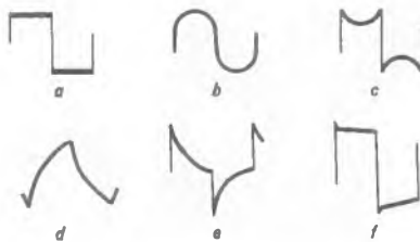
Bild 3. Oszillogramme eines Nf-Verstärkers: a = exakte Rechteckform (1 kHz), b = größte Höhen- und Tiefenbescheidung (1 kHz), c = größte Höhen- und Tiefenanhebung (1 kHz), d = Höhenbescheidung (5 kHz), e = Höhenanhebung (5 kHz), f = Rechteckimpuls von 50 Hz mit 5% Dachschräge (untere Grenzfrequenz)
