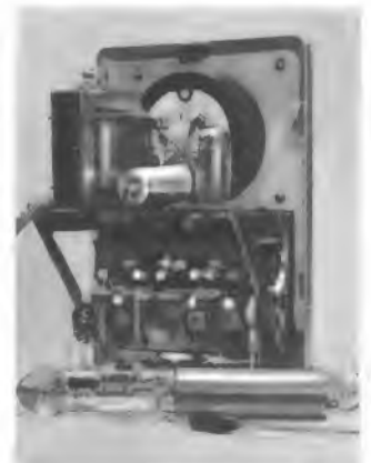
Bild 2. Die Innenansicht mit der gedruckten Schaltung
