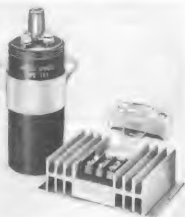
Bild 4. Die Transistor-Zündanlage Auto-Guide der holländischen Firma Terminal. Vorn der Leistungstransistor mit den Kühlrippen, dahinter die Siliziumdiode mit ihrer Kühlecke, links die Zündspule mit dem Übersetzungsverhältnis 1 : 250
