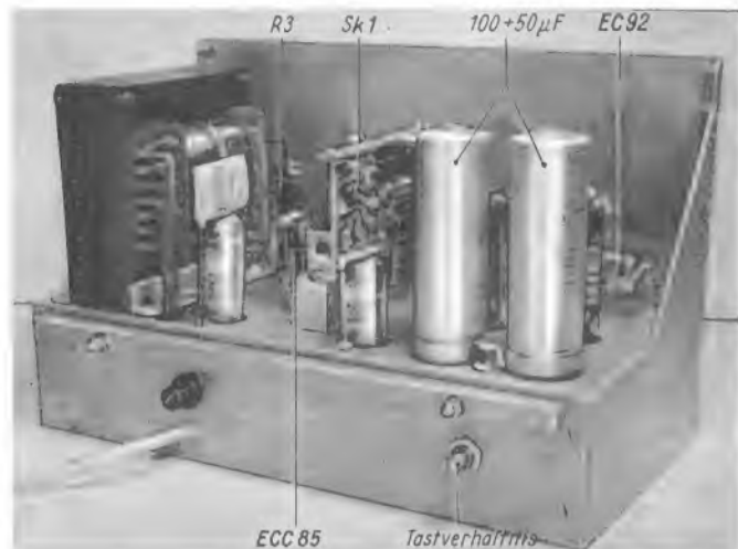
Bild 8. Verdrahtung oberhalb des Chassis
