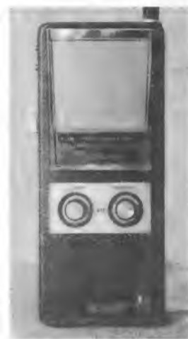
Bild 1. Handfunksprechgerät für den 27-MHz-Bereich mit zwölf Transistoren, Modell Tokai TC 130-G
