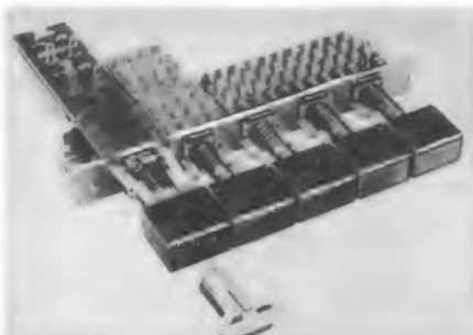
Bild 1. Schiebetastenschalter der Firma Rudolf Shadow KG, Berlin, mit verriegeltem Flachbauretzschalter, Schlüssel abgezogen
