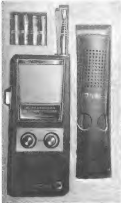
Bild 4. Verpackung des Gerätes in Plastik-Schaumstoff, ein passend profilierter gleichartiger Deckel wird vor Einschieben in den Versandkarton darübergestülpt
