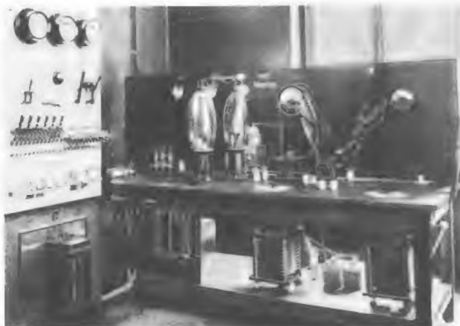
Bild 2. Sender Nr. 5 mit 0,75 kW Leistung am Magdeburger Platz (Telefunken)
