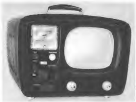
Bild 1. Tragbarer Fernsehempfänger mit eingebautem Selektiv-Verstärker und Meßzusatz
