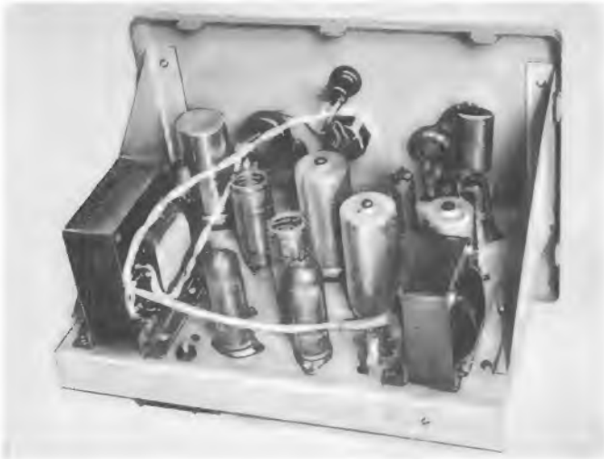
Bild 4. Die beiden Netztransformatoren finden auf der oberen Chassisseite Platz
