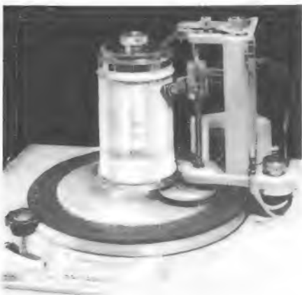
Bild 4. Schreibkopf und Zylinder mit Folie eines amerikanischen Aufzeichnungsgerätes für Sprache (Sona-Graph)
