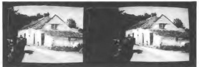
Bild 2. Normwandlung 625/405 Zeilen, links ein Fernsehbild mit 625 Zeilen, rechts das gleiche Bild nach Passieren des elektronischen Normwandlers und Umformung in 405 Zeilen
