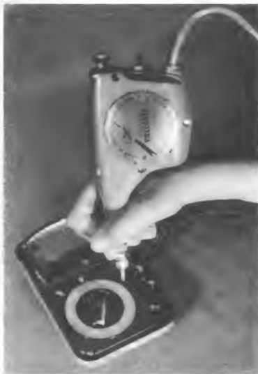
Eingravieren eines Eigentumszeichens auf einem Meßinstrument mit dem Vibrograv
