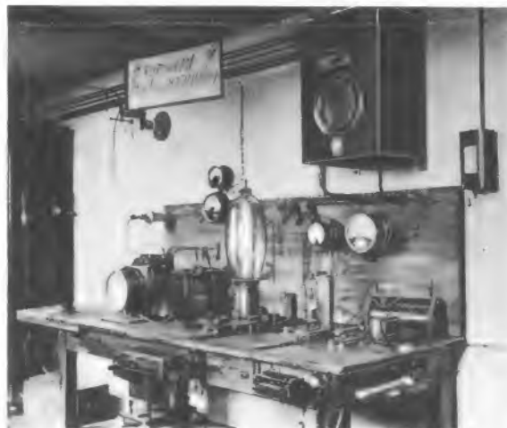
Bild 1. Der Berliner Sender Nr. 2 mit 0,25 kW Leistung, erbaut von Telefunken, aufgestellt im Voxhaus
