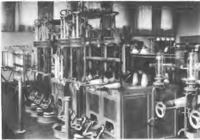
Bild 4. Endstufe des 100-kW-Großrundfunksenders (Sender Nr. 14) von Telefunken, Ende 1933 in Berlin-Tegel aufgestellt
