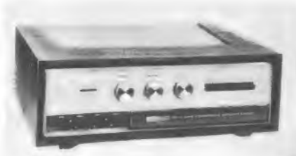
Bild 1. 70-W-Stereo-Verstärker. Der gedrungene Aufbau wird durch Transistorbestückung und Festkörperschaltkreise erzielt
