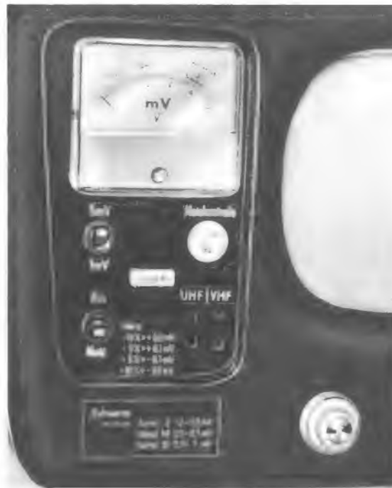
Bild 10. Die Frontplatte des Mustergerätes Kaiser „Prinz“. Zur Bedienung sind Hinweise bezüglich der erstrebenswerten Antennenspannungen und Zu- bzw. Abschlüge bei Netzspannungsschwankungen angebracht. Somit kann das Gerät auch mit Erfolg von Hilfskräften bedient werden
