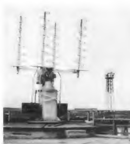
Bild 6. Die vierteilige Wendelantenne für die Grobortung des Satelliten mit Hilfe seiner dauernd ausgestrahlten Meldefrequenz von 136 MHz. Dahinter der 20 m hohe Turm zum Eichen dieses Grobradars und eines weiteren Präzisionsradars, das auf 1/100 Winkelgrad genau den Satelliten ortet
