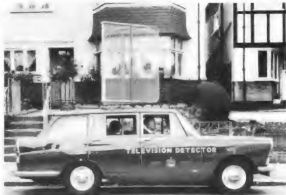
Links: Bild 1. Der neue Peilwagen der Britischen Postverwaltung mit Peilantenne und Panoramaempfänger zum Auffinden nicht angemeldeter Fernseh- und UKW-Rundfunkempfänger
