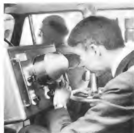
Unten: Bild 2. Der Beobachter am Panoramaempfänger; das Antennenhandrad ist deutlich sichtbar. Der Einblick ist gepolstert, um Verletzungen beim Arbeiten im Fahren zu vermeiden
