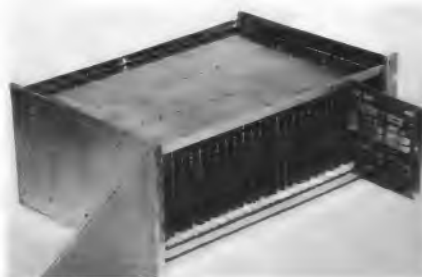
Bild 5. Zentraler Verstärkerkasten für 78 Transistorverstärker
