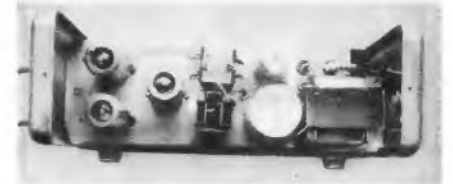
Bild 2. Der Vorverstärker ist auf U-förmig gebogenen Aluminiumblechen aufgebaut, die in Stahlblech-Gehäuse eingesetzt wurden
