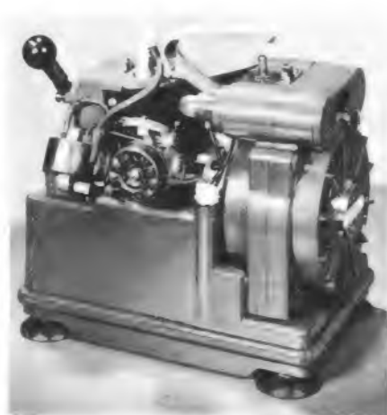
Bild 2. Gummipuffer sorgen für Erschütterungsdämpfung beim Betrieb des Aggregates
