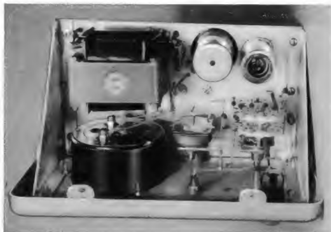
Links: Bild 10. Rückansicht des Gerätes. Die eingebaute Kaltgeräteamatur für den Netzanschluß ist mit einem Schutzkontakt versehen
