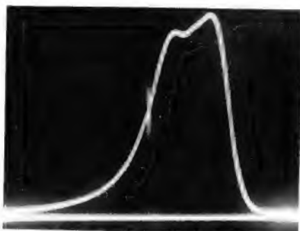
Bild 16. Verstimmt Oszillator; die Bildträger-marke 38,9 MHz liegt auf der linken Flanke der Kurve
