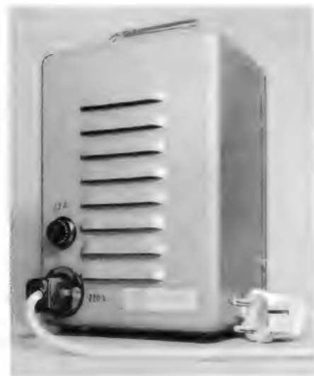
Links: Bild 10. Rückansicht des Gerätes. Die eingebaute Kaltgeräteamatur für den Netzanschluß ist mit einem Schutzkontakt versehen
