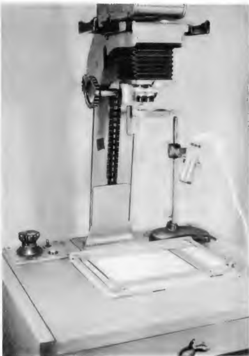
Bild 9. Praktisch ausgeführte Anordnung nach Bild 8. Links neben der Säule des Vergrößerers die Bedienungsknöpfe, rechts der Halter mit der Fühl-Optik. Die Elektronik ist im Schränkchen eingebaut
