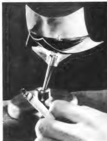
Kleiner Aluminiumreflektor mit Strahlungssammler für einen Solar-Generator
