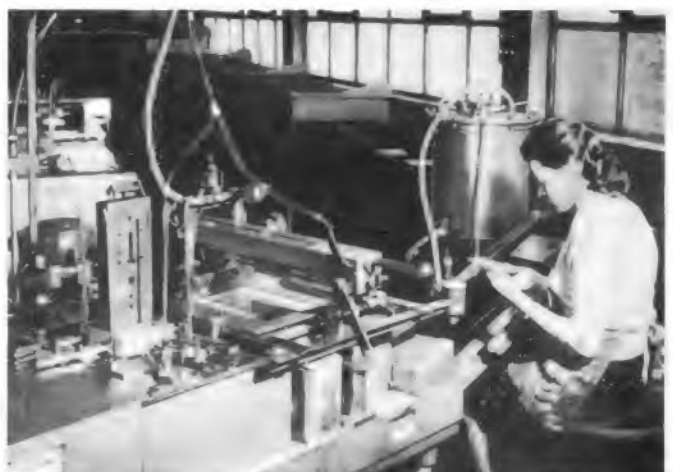
Bild 4. Siebdruck-Automat mit Perlonsieb zum Herstellen gedruckter Schaltungen
