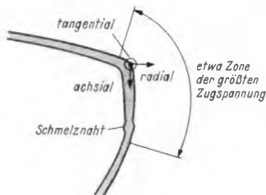
Bild 2. Schnitt durch die Bildröhre mit Angabe des Zugspannungsgebietes in der äußeren Faser
