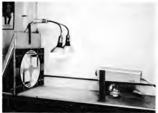
Bild 1. Mit der Philips-Transistor-Kamera EL 8 000 und einer Testbildvorlage kann man sich unabhängig von den Ausstrahlungen des Fernsehenders selbst ein Testbild erzeugen
