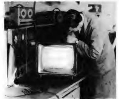
Bild 1. Mit der Philips-Transistor-Kamera EL 8 000 und einer Testbildvorlage kann man sich unabhängig von den Ausstrahlungen des Fernsehenders selbst ein Testbild erzeugen
