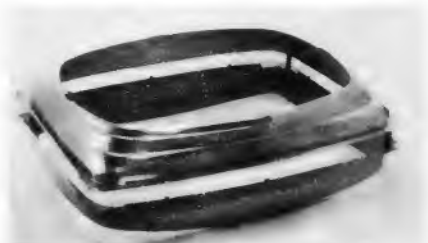
Bild 3. Vorder- und Rückteil der Armierung vor der Montage
