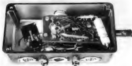
Bild 2. Die Schaltung ist in einem kleinen Bakelitkästchen untergebracht
