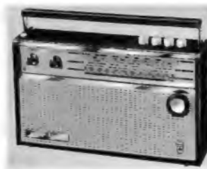
Bild 2. Reiseempfänger City-Boy 203 von Grundig. Abmessungen in cm: 26 × 16 × 7; Gewicht 1,8 kg
