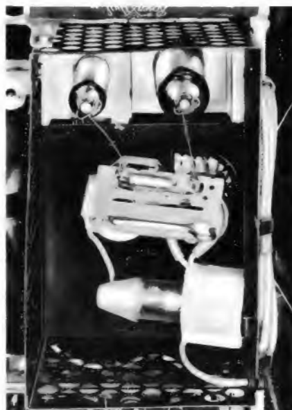
Bild 2. Zeilenkäfig im Tizian-Automatic nach Abnehmen des Schutzdeckels. Oben: PL 500 und PY 88; unten: DY 86. Mitte: Zeilenausgangsübertrager mit den hufeisenförmig angeordneten Anschlüssen
