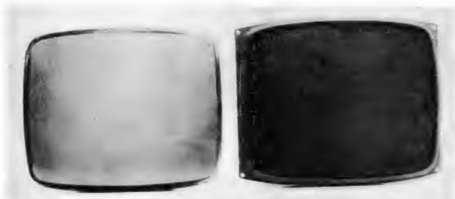
Bild 1b. Links der Röhrenkolben von vorn, rechts der armierte Kolben mit den Befestigungsaugen
