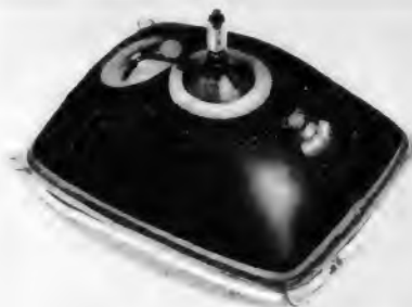
Bild 4a. Die neue Bildröhre A 59-11 W von Valvo; der Polyester-Überzug reicht fast bis zum Hals, der dunkle leitende Außenbelag ist auf die Polyesterschicht gespritzt
