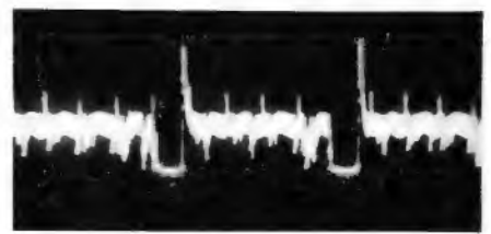
Bild 15. Gleichspannung an der Basis des Schalttransistors (Punkt B in Bild 6) bei einer Spannung von 15 V
