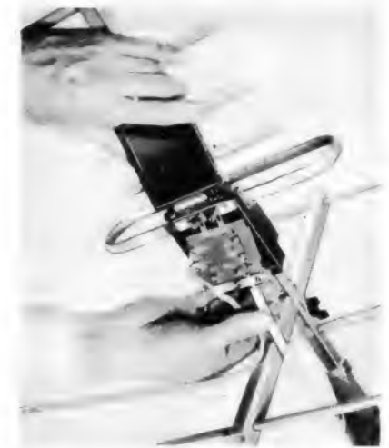
Bild 2. Der Verstärker-Baustein wird in die Dipoldose der Antenne eingesetzt
