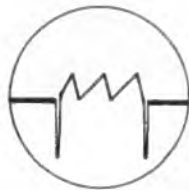
Bild 9b. Anschließend werden die unteren Spitzen zur Deckung gebracht und die Differenzspannung ermittelt
