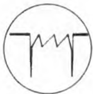
Bild 9a. Messen von Wechselspannungsanteilen; erst werden die oberen Spitzen zur Deckung gebracht
