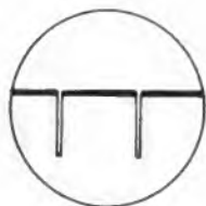
Bild 9a. Messen von Wechselspannungsanteilen; erst werden die oberen Spitzen zur Deckung gebracht
