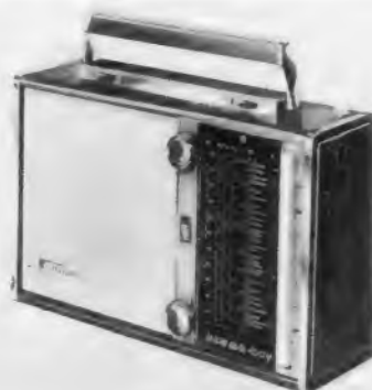
Ein moderner Kurzwellenempfänger: der Ocean-Boy 202 von Grundig. Dieser große Reisesuper mit neun Drucktasten enthält drei Kurzwellenbereiche, eine Hf-Vorstufe für alle Wellenbereiche und ein Drehspulinstrument für die Abstimmungsanzeige und zur Kontrolle der Batteriespannung
