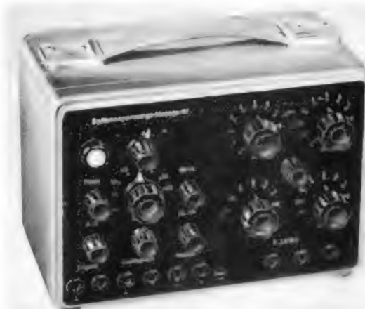
Links: Bild 11. Außenansicht des Mustergerätes. Auf der rechten Seite der Frontplatte wurde ein zusätzlicher Dekadenwiderstand 0...1,111 MΩ für Eichzwecke eingebaut
