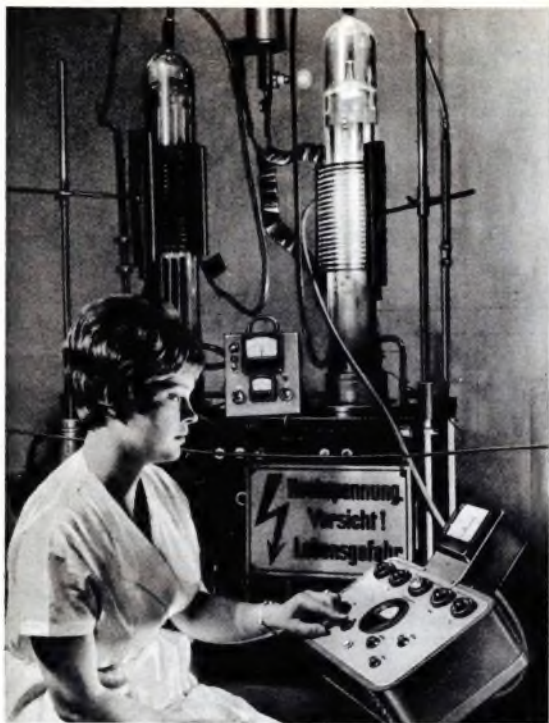
Ein Hochfrequenz-Glühstand zum Sintern und Glühen von Werkstücken in dem Senderöhren-Laboratorium der Telefunken-Werke Berlin
