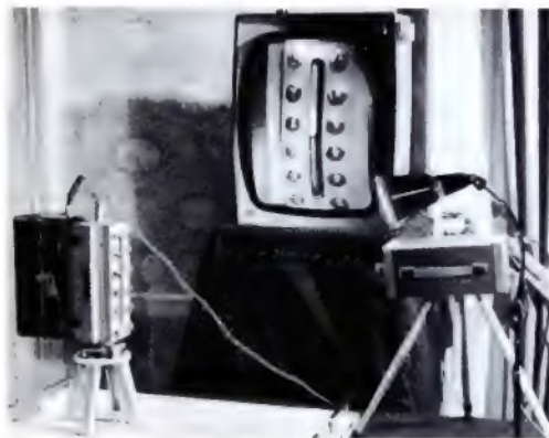
Bild 1. Transistorisierte Fernsehkamera, Typ 8, von EMI (rechts) beim Ablesen eines Wasserstands-anzeigers; in der Mitte das wiedergegebene Bild
