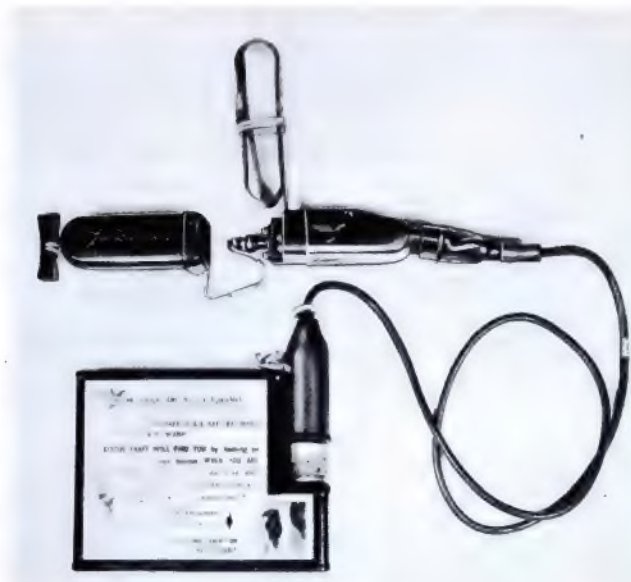
Bild 6. Such- und Rettungs-funkanlage Sarah mit einem 15-W-Sender auf der Frequenz 243 MHz
