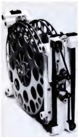
Bild 5. Kleines Tonbandgerät mit 4,75 cm/sec Bandgeschwindigkeit und 8 Stunden Aufnahmezeit (aus der Weltraumkapsel von John Glenn)
