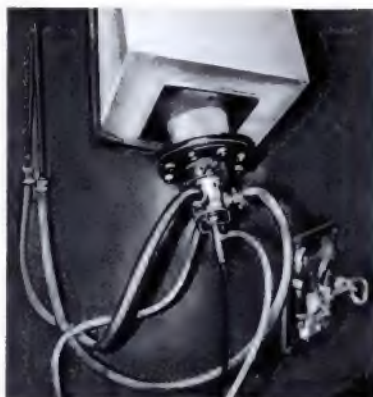
Bild 2. Wassergekühlte, an einen Ofen angebaute Philips-Fernseh-Kleinkamera mit Miniaturvidicon, hitzefest bis 2 000°C
