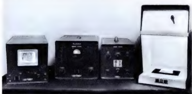
Bild 6. Such- und Rettungs-funkanlage Sarah mit einem 15-W-Sender auf der Frequenz 243 MHz
