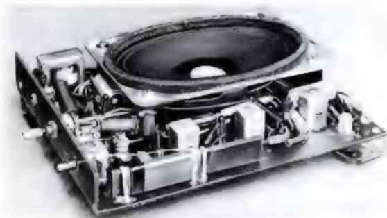
Bild 4. Die Verdrahtung der Chassisplatte
