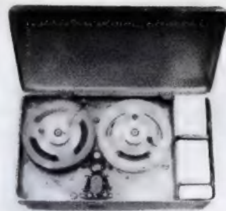
Bild 4. Bei geöffnetem Deckel werden die Bandspulen wie bei jedem anderen Bandgerät eingelegt. Man erkennt Tonkopf und Tonrolle; rechts die Batterien für den Verstärker
