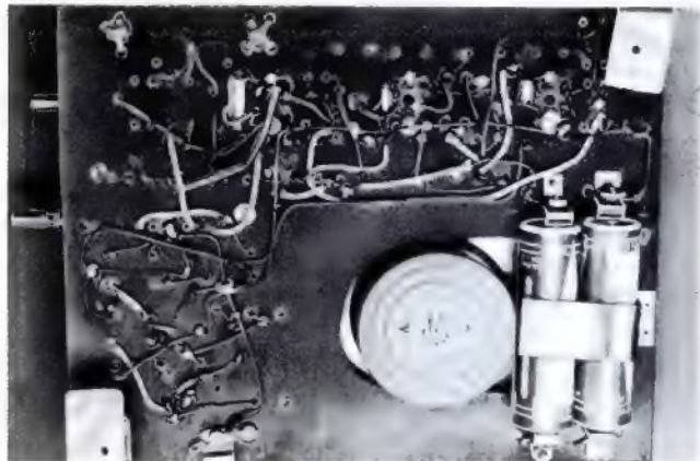
Bild 4. Die Verdrahtung der Chassisplatte
