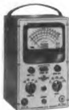
Service-Röhrenvoltmeter in Brückenschaltung mit 25 M $\Omega$  Eingangswiderstand bei Gleichspannung. 0—1000 V $\approx$ , 0—1000 M $\Omega$  in je 5 Bereichen. Eigene dB-Skala, Anzeigeinstrument 8x12 cm. 220 V.
