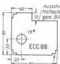
Bild 10. Oszillatorchassis aus 2 mm starkem Hartpapier
