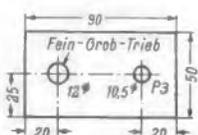
Bild 11. Halteplatte für Grob-Fein-Trieb aus 2 mm starkem Hartpapier
