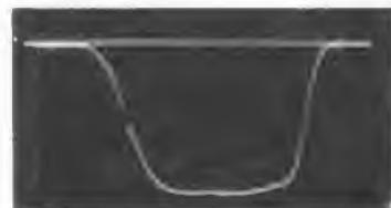
Bild 10. Gesamtdurchlaßkurve (Hf + Zf) eines Fernsehempfängers
