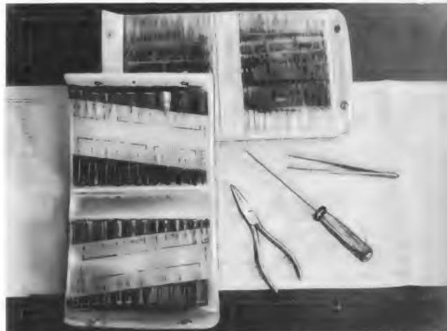
Bild 1. Die Servix-Taschen enthalten jeweils eine gut sortierte Auswahl von Widerständen bzw. Wickelkondensatoren für Ersatzzwecke in der Werkstatt oder beim Kunden. Zusammengeklappt und durch Druckknöpfe verschlossen lassen sie sich gut transportieren
