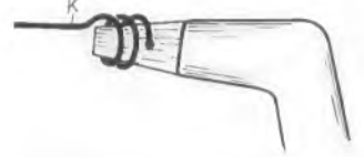
Bild 2. Die Anbringung der Kupferdrahtspitze K an einer normalen Lötkolbenspitze mit Hilfe der Bohrung B
