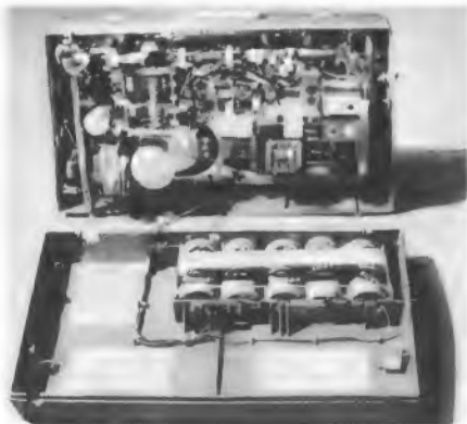
Bild 7. Blick in den Picnic 3291 von Telefunken mit 5 Monozellen als Stromquellen
