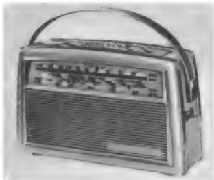
Bild 4. Toxy, Modell 32 355, mit drei Wellenbereichen und Sprache/Musik-Taste (Loerøe-Opta)
