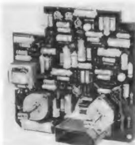
Links: Bild 3. Gesamter Schaltungsaufbau auf der Bestückungssseite der gedruckten Schaltplatte
