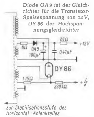
Bild 3. Sekundärseite des Zeilenausgangsübertragers im Versuchs-Fernsehempfänger von Valvo
