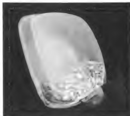
Bild 2. Schutzhülle nach einer künstlich herbeigeführten Implosion der Bildröhre
