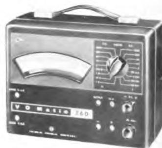
pro Volt Wechselstrom. Genauigkeit:  $\pm 3\%$  bei Gleichstrom,  $\pm 5\%$  bei Wechselstrom (volle Skala). Polwechschalter.
