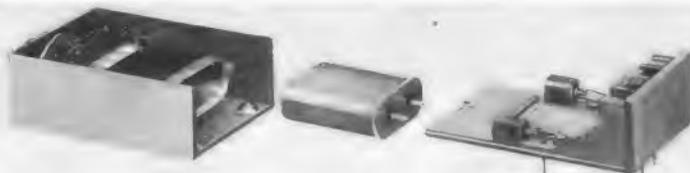
Oben: Bild 2. Siemens-Kleinthermostat für Schwingquarze mit stetiger Wärmeregulation durch eine Halbleiterschaltung. Von links nach rechts: Gehäuse-Oberteil mit Heizwicklung, Schwingquarz, Unterteil mit Regelschaltung
