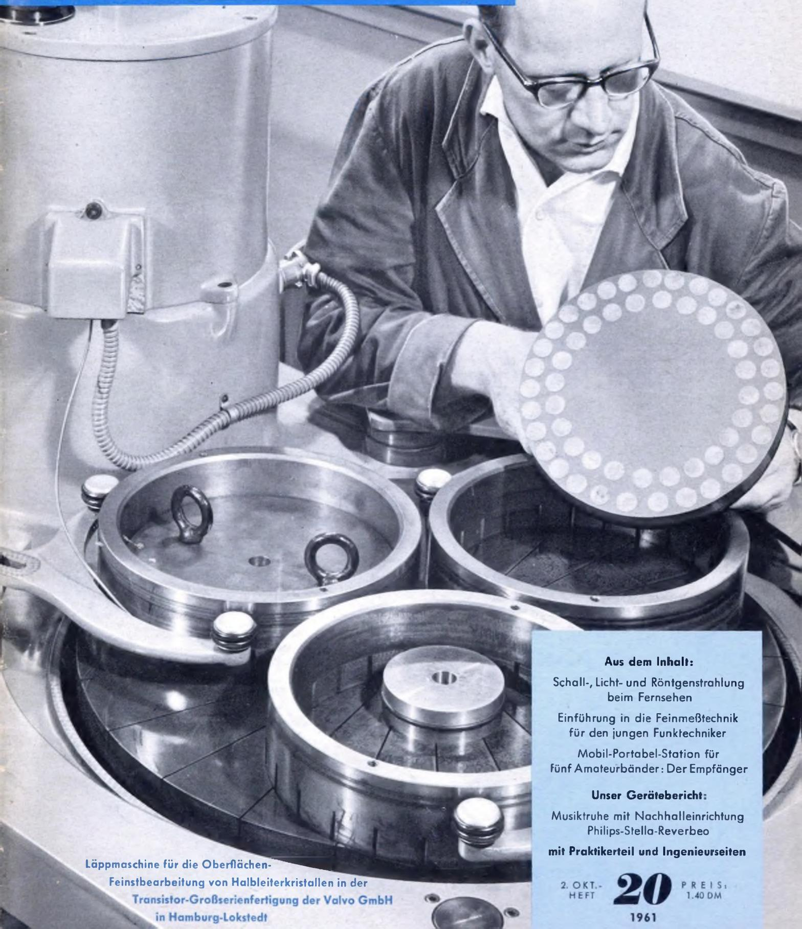
Läppmaschine für die Oberflächen-
