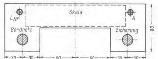
Bild 8. Maße der rückseitigen Chassis-Versteifung
