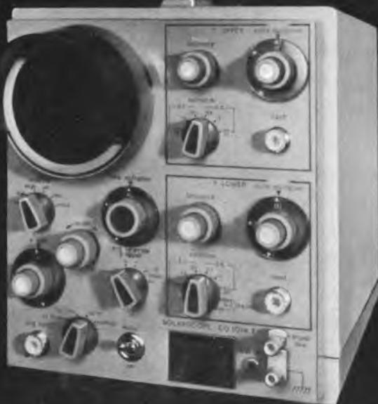
0 - 5 MHz Bandbreite 100 mV/cm · Eingebauter  $Y_1$  Vorverstärker · Getriggerte Zeitbasis, modernste Schaltungstechnik · Echte Doppelstrahlröhre mit Planschirm 9 cm  $\phi$  Geeichte Zeit- u. Amplitudenmessung · Tastkopf lieferbar.
