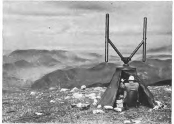
Er peilt in den Bergen: Der Ermittlung des genauen Standortes weitentfernter oder auch unbekannter UKW-Sender dient eine besondere, auf Bergen oder hohen Gebäuden stationierte Empfangs- und Peilanlage. Ein Tonbandgerät ermöglicht eine Dokumentation des mit der Anlage aufgenommenen Nachrichteninhaltes und das Einblenden von Beobachtungsmitteln des Peilfunkers über ein Mikrofon (Aufnahme: Telefunken)
