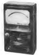
$\pm$  2%. = und  $\sim$ : 20 000  $\Omega$ /V.  $\sim$ : 10 000  $\Omega$ /V. 10 — 50 — 250 — 500 — 1000 V. = 50 mV/50  $\mu$ A — 2,5 — 25 — 250 mA. Ohm: 0,5  $\Omega$ ...5 M $\Omega$  — R  $\times$  1 —  $\times$  10 —  $\times$  100 —  $\times$  1000. — 20...+22 dB. Spiegelskala.
