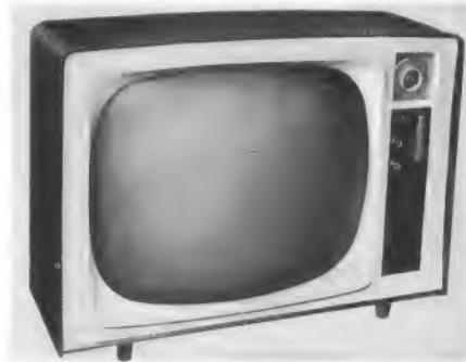
Bild 1. 110°-Fernsehempfänger im asymmetrischen Gehäuse (Ducretet-Thomson)
