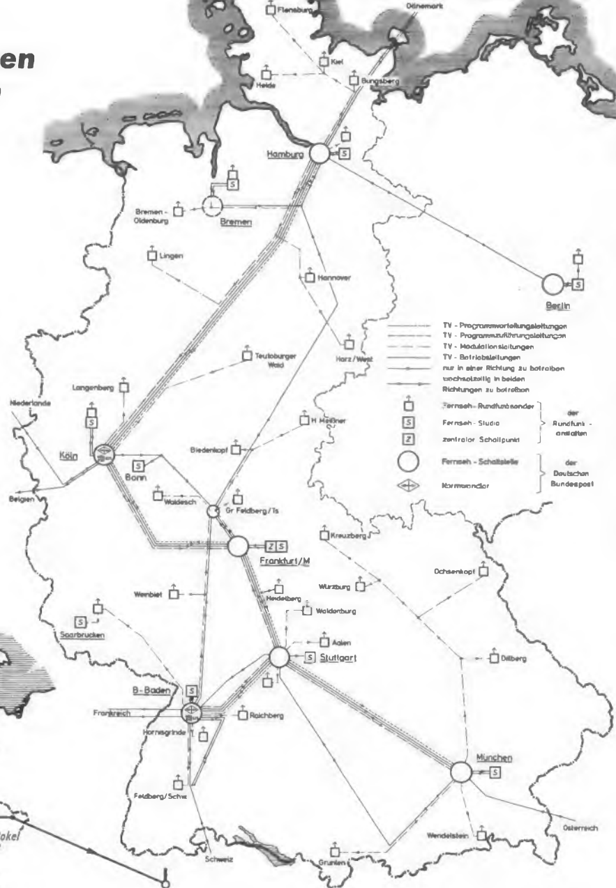
Bild 1. Fernseh-Richtfunkstreckennetz der Deutschen Bundespost für das 1. Programm
