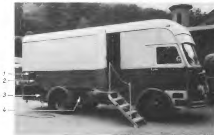
Bild 1. Der Bildaufzeichnungswagen des Südwestfunks mit Ampex VR 1000. 1 = Abluft von der Kühlmaschine der Klimaanlage; 2 = Zuluft für Klimaanlage; 3 = Netzkabeltrommel, Reservekabel und Kommandoleitungen; 4 = Vf- und Nf-Kabeltrommeln und Anschlußfeld außen
