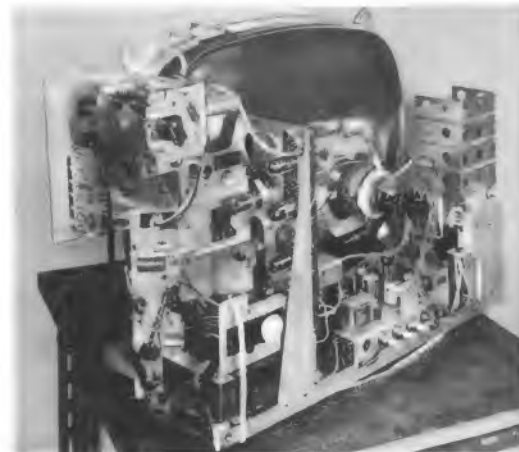
Bild 2. Vertikal angeordnetes, jedoch nicht ausschwenkbares Chassis des in Bild 1 gezeigten Fernsehempfängers. Alle Baugruppen sind steckbar und daher leicht austauschbar
