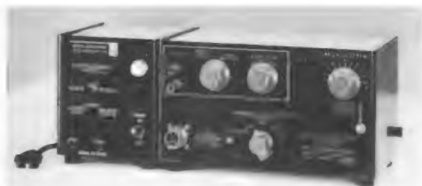
Bild 1. Die Ansicht des Zeit/Frequenz-Eichgerätes (rechts) und des zugehörigen Netzgerätes (links)
