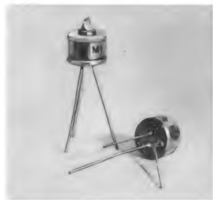
Bild 3. Die äußere Form der Siemens-Mesa-Transistoren; die Systeme sind in einer dicht abgeschlossenen Metallkappe untergebracht, die zur Wärmeableitung großflächig mit dem Kollektor leitend verbunden ist
