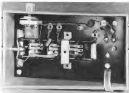
Bild 3. Drucktastenschaltung und Abstimmkondensator im Sockel der Antenne
