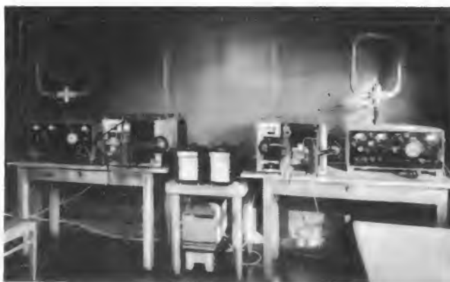
Bild 7. Feldstärkemeßgeräte mit Rahmenantennen, Pegelanalysatoren mit automatischen Kameras und Linienschreiber im hölzernen Feldstärke-Meßhaus (siehe auch das Titelbild von Heft 2)
