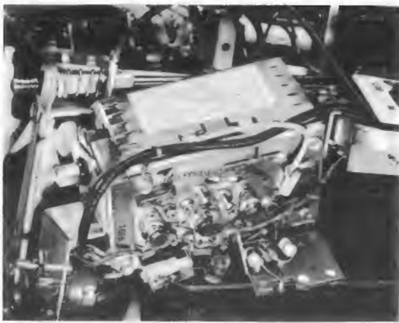
Bild 4. Kanalschalter des Astronaut mit drei Transistoren. Es handelt sich um eine gemeinsame Entwicklung der Firmen Motorola und Standard Coil
