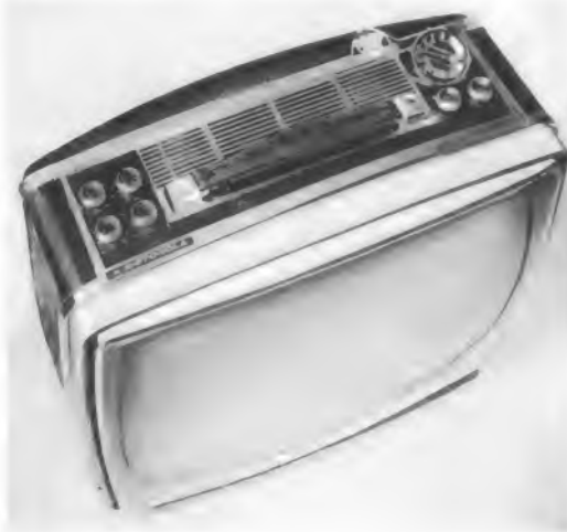
Bild 1. Volltransistorisierter, mit eingebautem Akkumulator oder am Netz zu betreibender Fernsehempfänger Motorola-Astronaut mit 43-cm-Bildröhre
