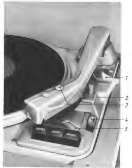
Rechts: Bild 4. Tonarm und Bedienungsteil; 1 = Tonarm-Arretierung für den Transport, 2 = Waage für Auflagegewicht (der Tonarm ist im Bild auf die Waage aufgelegt), 3 = Schraube zum Lösen des Tonabnehmersystemes, 4 = Taste Manual für den Betrieb als einfacher Plattenspieler, 5 = Skala und Zeiger der Waage
