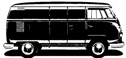
VW-Kastenwagen: 4,8 cbm Laderaum; 830 kg Nutzlast; große Zweiflügel-Tür an der Gehsteigseite.
