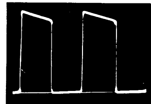
Bild 4. Oszillogramm eines Rechteckgenerators mit Glimmröhren
