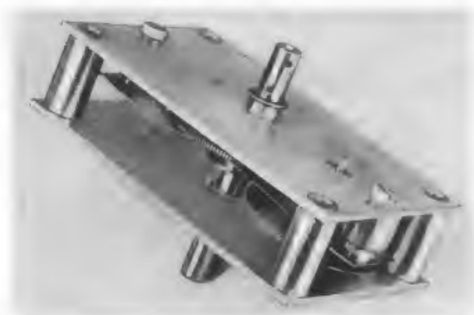
Bild 1. Grob-Fein-Antrieb mit eingebauter Übersetzung i = 1 : 1 / 1 : 16
