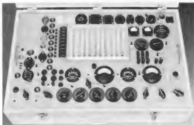
Bild 1. Blick auf das fertige Röhrenmeßgerät. Das weiße Tastenfeld stellt den Kreuzschienenverteiler dar
