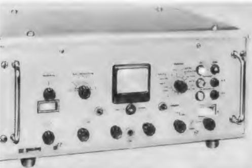
Bild 7. Kurzwellen-Steuersender mit digitaler Anzeige (Ziffern-Anzeige) in den kleinen Fenstern oberhalb der fünf unteren Einstellknöpfe. Der sechste Knopf rechts unten betätigt über den beschriebenen Grob-Fein-Antrieb die Skala für Werte unter 1000 Hz
