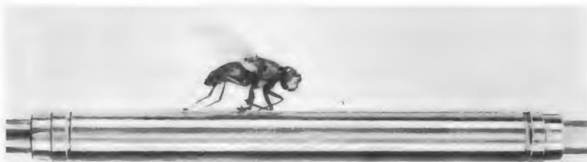
Bild 1. Die minimalen Abmessungen (knapp 40 mm Länge, 4 mm Durchmesser) des Verstärkers werden im Größenvergleich mit einer gewöhnlichen Stubenfliege deutlich
