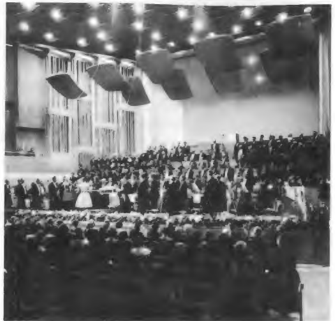
Bild 5. Das große Orchester- und Chorpodium im Großen Sendesaal des SFB mit den beweglichen Schall-Reflektoren
