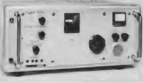
Bild 5. Empfänger E 148 UKW für 25...84 MHz in einem Bereich. Die Spiralskala ist insgesamt 2400 mm lang. Durch eine in der Höhe sich verstellende Blende wird nur der jeweils geltende Ausschnitt der Teilung sichtbar gemacht. Die Reproduzierbarkeit der Einstellung beträgt etwa \pm 25 kHz bei 75 MHz
