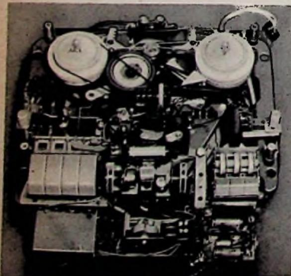
Bild 4. Tasten- und Antriebsmechanik des Grundig-Tonbandkoffers TK 55
