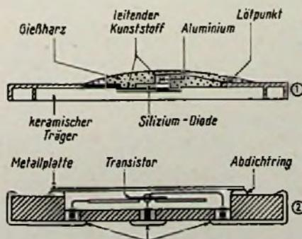
Metallisierte Transistoranschlüsse führen zu Kontaktflächen des nächsten keramischen Trägers
