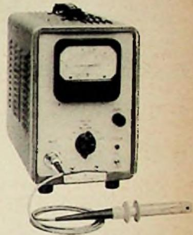
Röhren-mA-Meter mit Stromlastkopf
