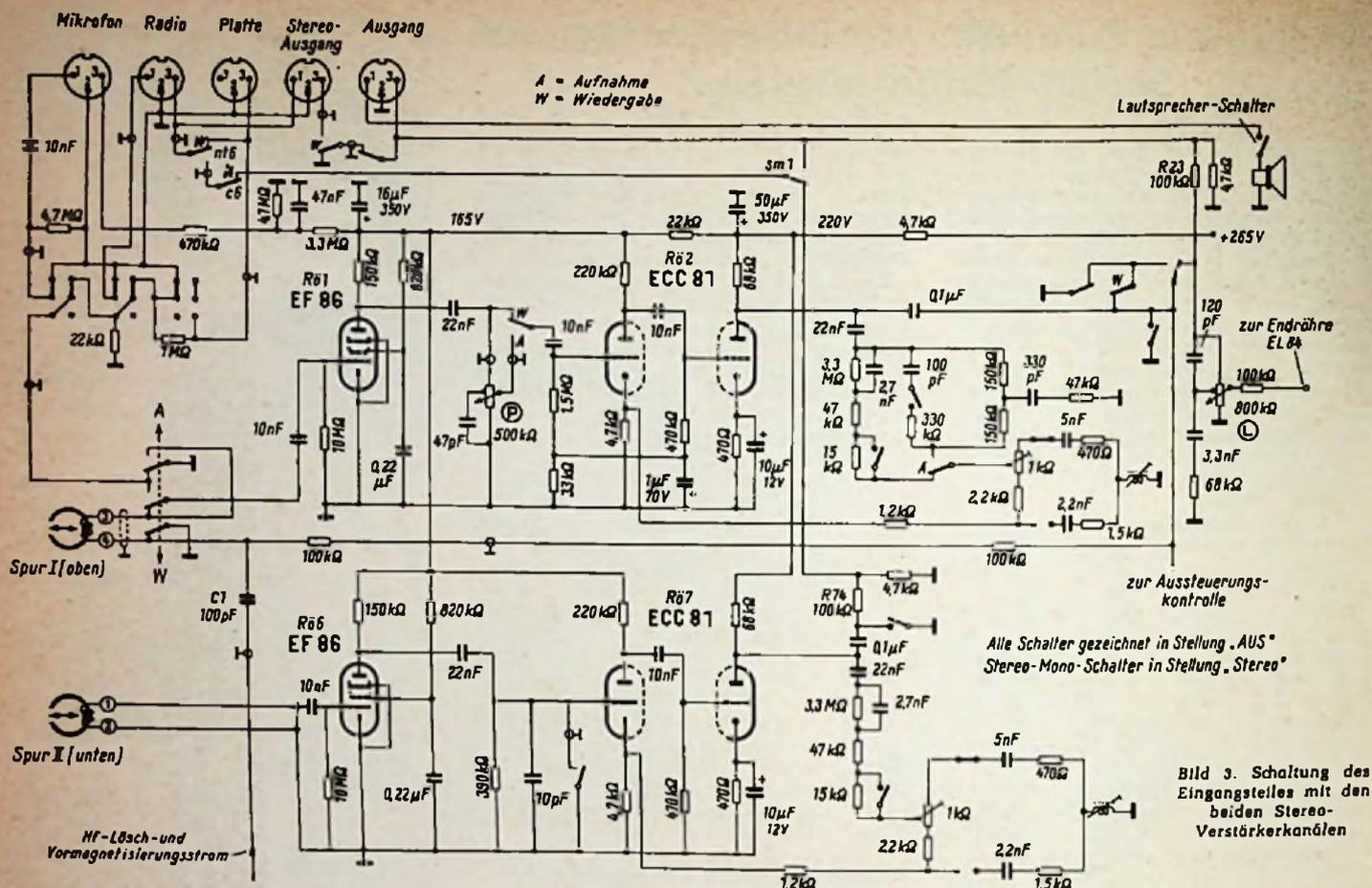
Bild 3. Schaltung des Eingangsteiles mit den beiden Stereo-Verstärkerkanälen
