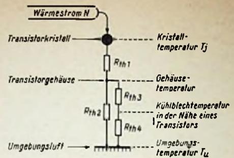
Bild 3. Ersatzbild für die Wärmeableitung mit Kühlblech:
