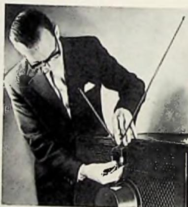
Bild 4. Mit wenigen Handgriffen ist die Siemens-Teleskop-Helmontenne an der Rückwand eines Fernsehempfängers zu befestigen. Ist das Gerät nicht in Betrieb, so können die Fühler eingezogen werden, so daß die Antenne unsichtbar bleibt
