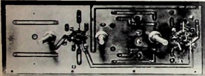
Links: Bild 6. Die Schaltung der Vorstufe in gedruckter Verdrahtung
