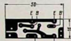
Bild 2. Die Verdrahtung des Signal-Injektors in gedruckter Schaltungsweise
