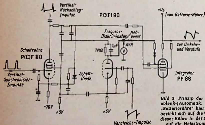
Bild 3. Prinzip der Vertikal-(Bildablenk-)Automatik. (Der Ausdruck „Batterieröhre“ hier und in Bild 1 bezieht sich auf die Wirkungsweise dieser Röhre in der Schaltung, nicht auf die Heizstromversorgung)
