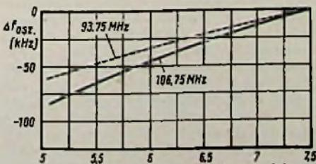
Bild 2. Frequenzabweichung des UKW-Oszillators bei Änderung der Batteriespannung
