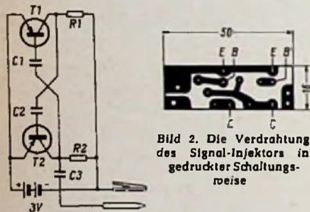
Bild 1. Die Schaltung des Signal-Injektors
