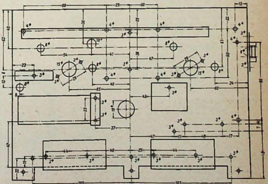
Bild 11. Bohrplan der Chassisplatte
