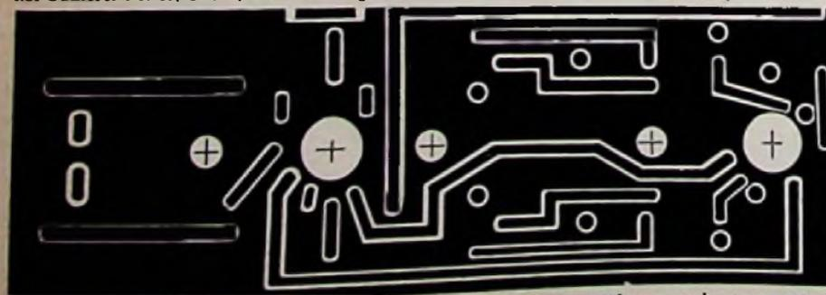
Bild 7. Axtschablone [gegenüber Bild 6 wurde nachträglich die Leitungsführung noch etwas geändert]
