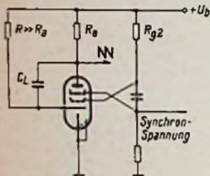
Bild 2. Prinzip des Vertikal-Integrators (Bildfrequenz-Oszillator aus der Familie der „Phaniastron“)
