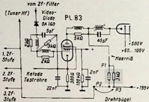
Bild 2. Die Schaltung der ausgefallenen Video-Endstufe mit dem Spezialwiderstand
