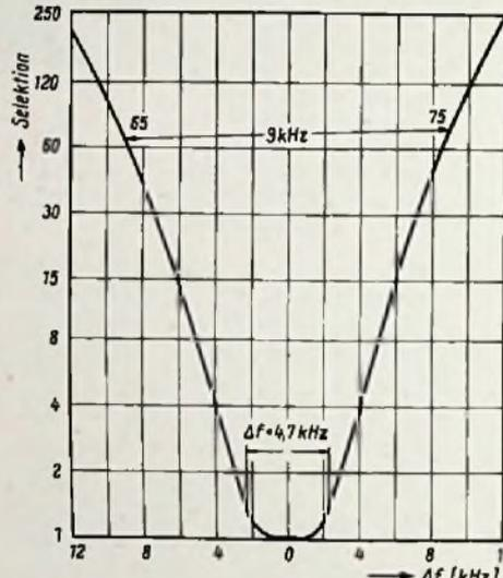
Bild 3. Gesamtdurchlaßkurve bei AM-Betrieb
