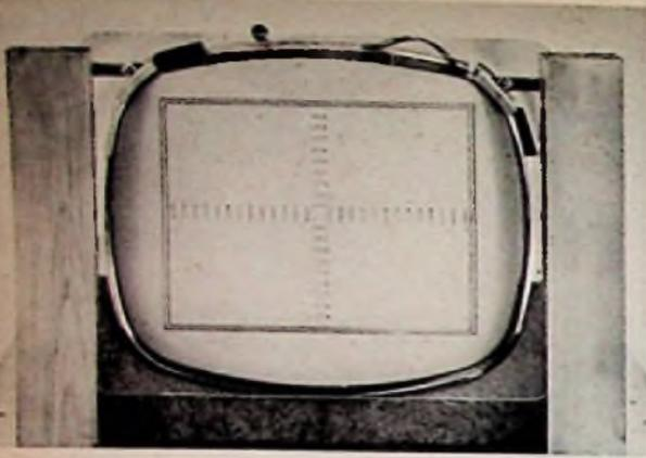
Meßordnung für 110°-Bildröhren im Applikationslaboratorium der Valvo GmbH. Diese Einrichtung dient zur Ermittlung der benötigten Ablenkleistung, der Vertikal- und Horizontal-Linearität, Bildbreite, Verschiebung der Horizontal-Synchronisation und Geometrie (Kissen- und Tonnen-Verzeichnung). Zur parallaxefreien Ablesung wurde sowohl die Vorder- als auch die Rückseite der Schutzscheibe mit Teilung versehen
