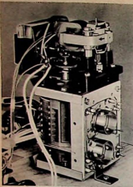
Kanalschalter für Band III mit Motordrehwähler im Luxus-Fernsehempfänger (Siemens)
