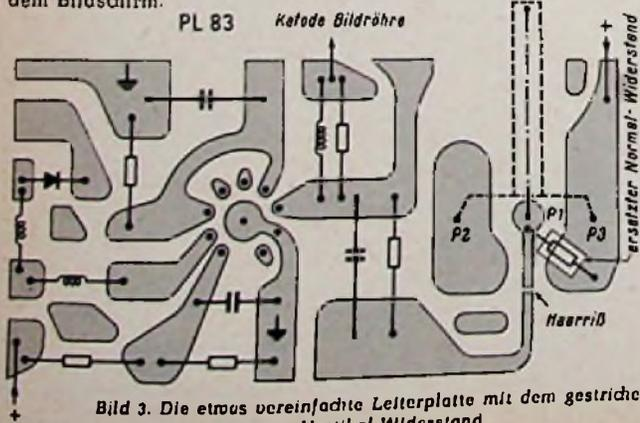
Bild 3. Die etwas vereinfachte Leiterplatte mit dem gestrichelten Vertikal-Widerstand
