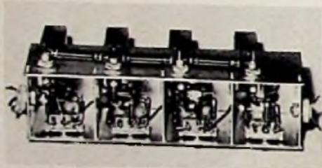
Bild 5. Unteransicht des Chassis mit den Schirmkammern
