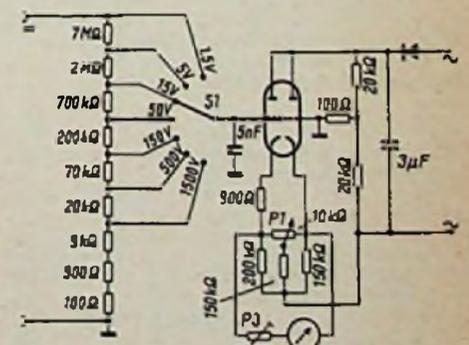
Bild 4. Prinzipschaltung für Gleichspannungsmessungen
