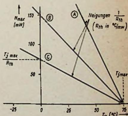
Bild 2. Zulässige Maximalleistung in Abhängigkeit von der Umgebungstemperatur für  $T_j \text{ max} = 75^\circ \text{C}$ : (A)  $R_{th} = 0,25^\circ \text{C/mW}$ ; (B)  $R_{th} = 0,5^\circ \text{C/mW}$ ; (C)  $R_{th} = 1,0^\circ \text{C/mW}$ . Kennlinie (B) trifft für den Siemens-Transistor TF 65 zu
