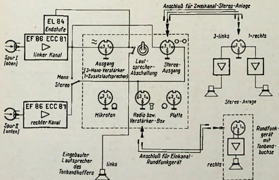
Bild 2. Anschließung des TK 55 an eine Stereo-Anlage oder ein Rundfunkgerät für die Wiedergabe von Stereo-Tonbändern. (Es sind nur die Ausgangsvorbinderungen der Anschlußbuchsenplatte des Tonbandgerätes dargestellt)
