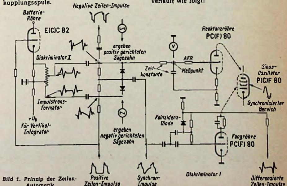
Bild 1. Prinzip der Zeilen-Automatik
