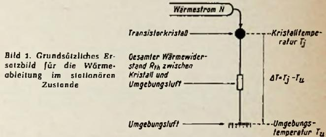
Bild 1. Grundsätzliches Ersatzbild für die Wärmeableitung im stationären Zustande
