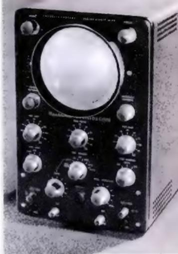
Bild 1. Ansicht des Heathkit-Oszillografen OM-3
