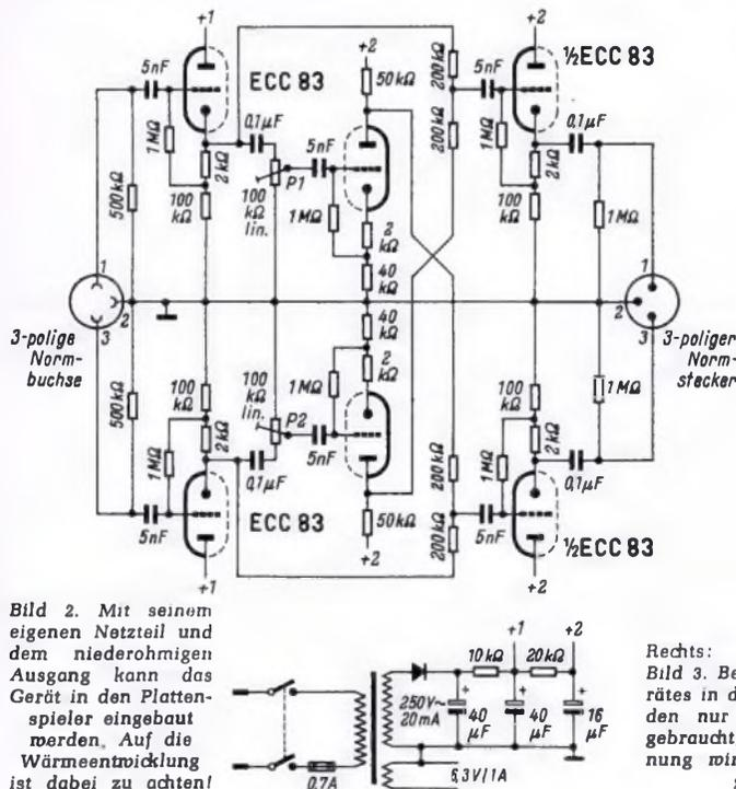
Bild 2. Mit seinem eigenen Netzteil und dem niederohmigen Ausgang kann das Gerät in den Plattenspieler eingebaut werden. Auf die Wärmeentwicklung ist dabei zu achten!
