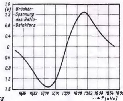
Bild 5. Verlauf der Brückengleichspannung des in Bild 4 skizzierten Ratiodetektors
