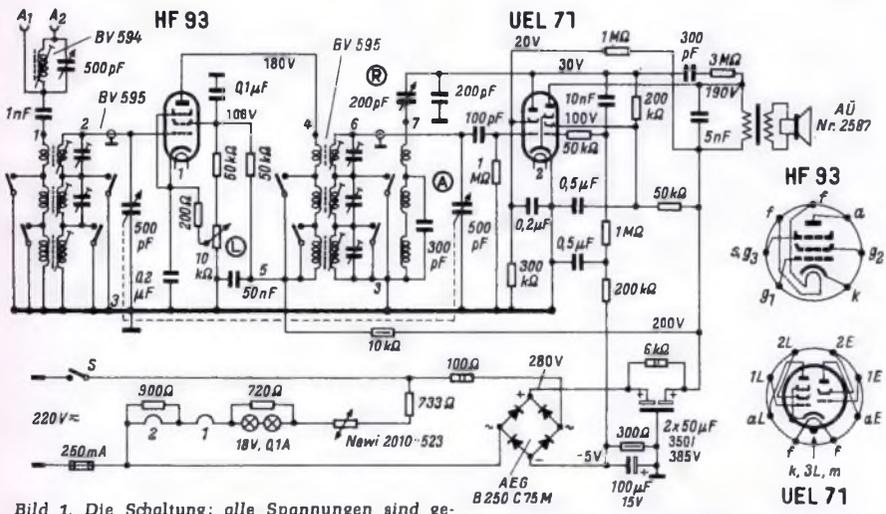
Bild 1. Die Schaltung; alle Spannungen sind gemessen mit einem Voltmeter mit 1000 Ω/V, Meßbereich 500 V
