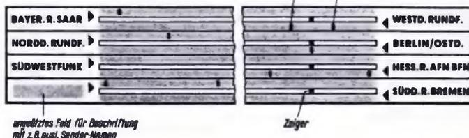
Bild 8. Magisches Prisma im Siemens-Super E 9
