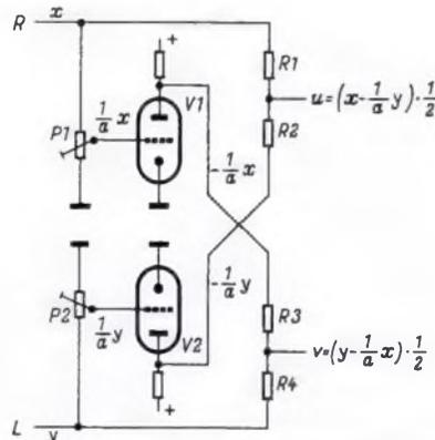
Bild 1. Prinzipschaltung des Gerätes zur Erhöhung der Übersprechdämpfung
