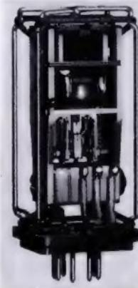
◀ Bild 1. Meß-Zerhacker der Firma Kupfer-Asbest-Co. (Gehäuse abgenommen)
