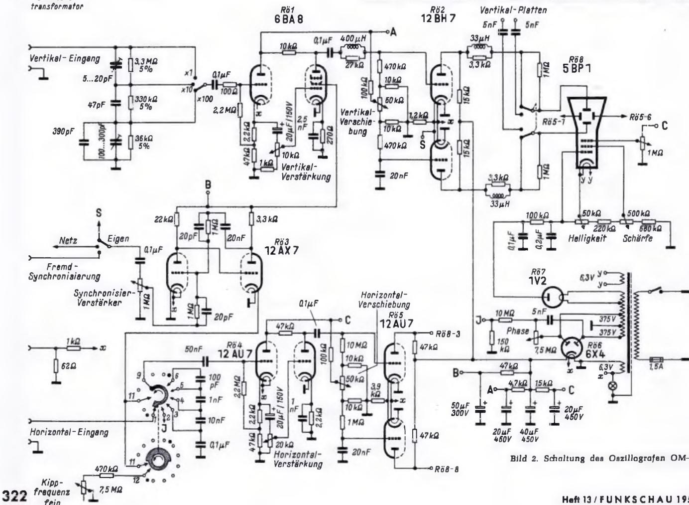
Bild 2. Schaltung des Oszillografen OM-3
