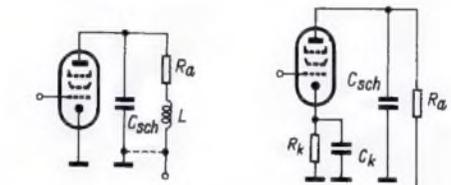
Bild 17. C-Kompensation bei der oberen Grenzfrequenz
