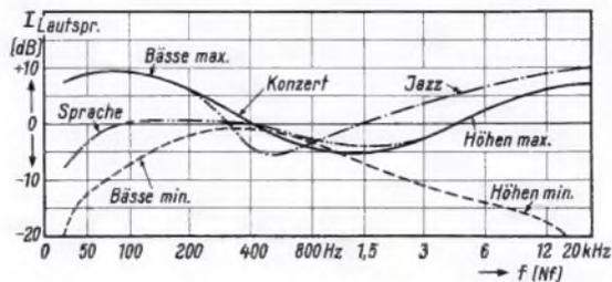
Bild 8. Frequenzkurven des Philips-Saturn, Kanal 1, Lautstärkeeinstellung -40 dB
