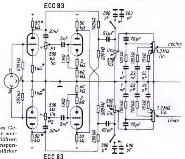
Rechts: Bild 3. Beim Einbau des Gerätes in den Verstärker werden nur zwei ECC-Röhren gebraucht, die Anodenspannung wird vom Verstärker genommen
