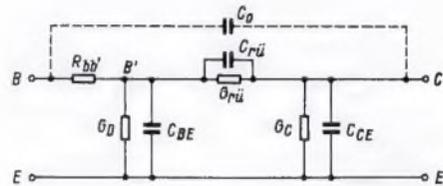
Bild 7. Das Ersatzschaltbild des Transistors (in  $\pi$ -Darstellung)
