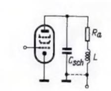
Bild 16. L-Kompensation bei der oberen Grenzfrequenz
