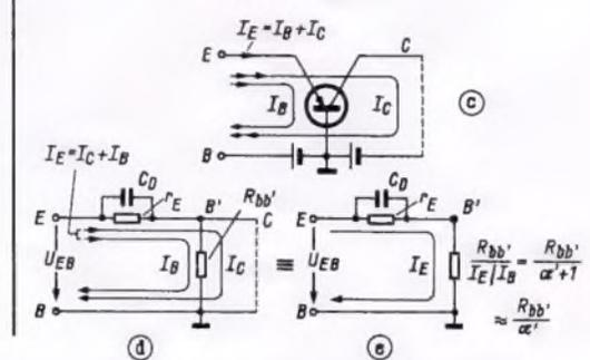
Der Steuerleitwert ist von besonderer Bedeutung, stellt er doch die Belastung dar, die durch die Steuerstrecke erzeugt wird.
