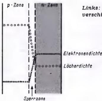
Links: Bild 1. Der Dichtenübergang zwischen zwei verschieden dotierten Zonen und die Bildung einer Sperrschicht
