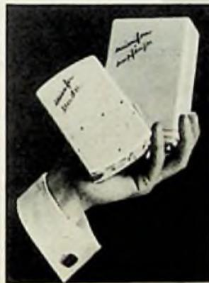
Bild 3. Mini-Taschen-Sender und -empfänger für drahtlose Tonbandbesprechung
