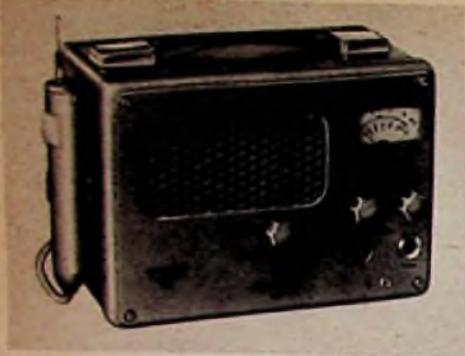
Bild 7. Grundig-Signalverfolger SV 1
