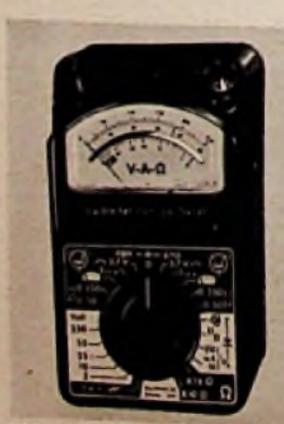
Bild 11. Das Halbleiter-Service-Prüfgerät von Max Funke
