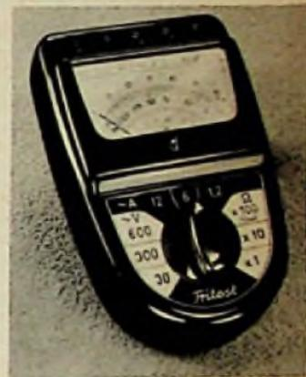
Bild 3. Gossen-Tritest, ein Vielfachmessgerät in neuer Form
