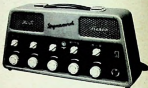
Hi-Fi-Stereoverstärker SMV auch für Stativbetrieb, in beliebiger Kombination mit DYNACORD-Stereo-Leistungsstufen 2x8, 2x15 und 2x 25 Watt; erste deutsche Stereo-Anlage für Orchester und Bühnenkünstler: 5 Instrumenten- und Mikrofon(stereofon)- Eingänge, jeder Eingang mit eigener Klängeinstellung. br. DM 350.-
