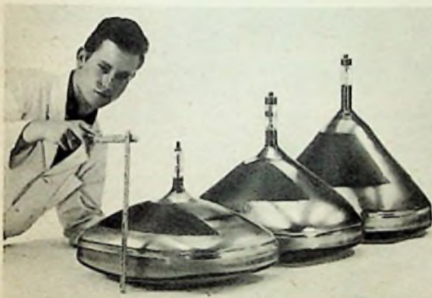
Bild 1b. Fernsehbildröhren (von links nach rechts) für 110°, 90° und 70° Ablenkung. (Nach Unterlagen der Standard Elektrik Lorenz AG)
