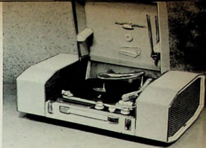
Die Saba-Hi-Fi-Stereokombination besteht aus einem Stereo-Verstärker mit zwei Kanälen und vier Lautsprechern, die paarweise an den beiden Seiten angeordnet sind, und einem Dual-Plattenwechsler. Wahlweise kann außerdem ein UKW-Super eingebaut werden. Die beiden im Bild sichtbaren seitlichen Klangstrahler lassen sich vom Mittelteil abnehmen und in weiterem Abstand als Stereolautsprecher anordnen
