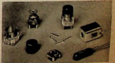
Bild 3. Die Kleinheit der Spulenbauteile von Vogt & Co kann man an dem zum Vergleich rechts vorn liegenden Transistor abschätzen
