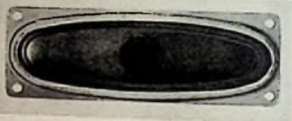
Bild 5b. Der neue sehr niedrige Lorenz-Lautsprecher LP 0310 für Tisch-Fernsehempfänger
