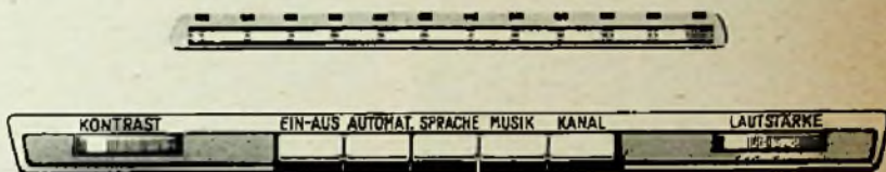
Bild 6. Bedienungsplatte der neuen Siemens-Luxusfernseh-Empfänger mit Taste für motorbetriebene Kanalwahl und Kanalskala
