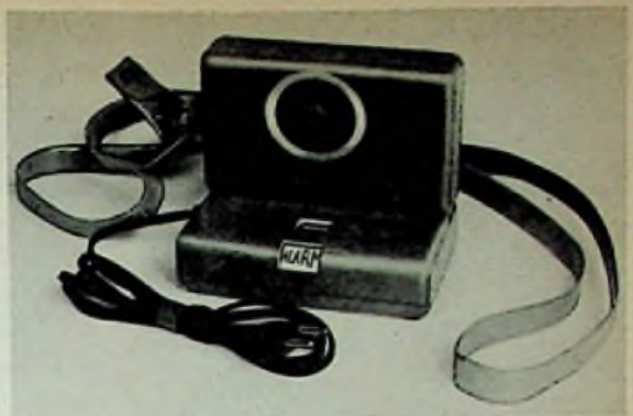
Bild 1. Alarm- und Meldeempfänger für den 80-MHz-Bereich. Er ist volltransistorisiert und wiegt nur 800 g
