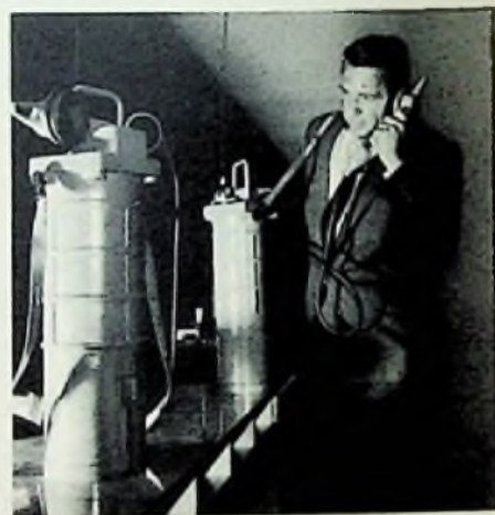
Ein äußerst stabiles Fußgehäuse, das allen rauen Beanspruchungen des Grubenbetriebes widersteht, schützt das schlagwittersichere Siemens-Funk-sprechgerät für den Bergbau
