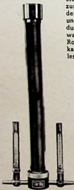
Bild 1. Hochleistungs-Schichtwiderstand für maximal 20 kW Belastung mit Wasserkühlung
