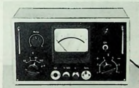
Bild 4. Ansicht des Gleichspannungs-Röhrenvoltmeters mit hochohmigem Eingang
