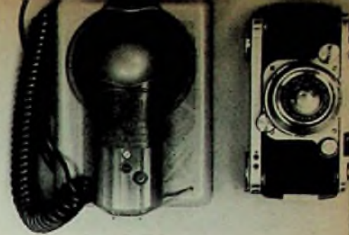
Bild 1. Die Abmessungen des Ultrablitz Cornet der Deutschen Elektronik GmbH im Vergleich zu einer Kleinbildkamera (Lampenteil zum Transport auf dem Stromversorgungsteil befestigt)
