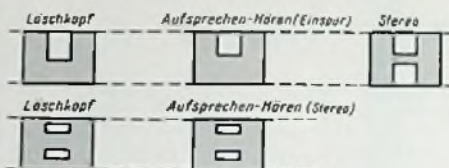
Bild 1. Obere Reihe: Logo der Köpfe beim normalen Doppelspurband. Unten: Löschkopf sowie der kombinierte Aufsprech/Hör/Stereo-Kopf von Shure Brothers
