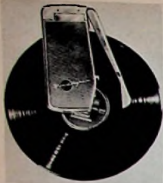
Bild 1. Dieser vom Lichtnetz unabhängige Taschen-Plattenspieler arbeitet mit Transistorverstärker, 6-V-Batteriemotor und rückwärtigem Lautsprecher
