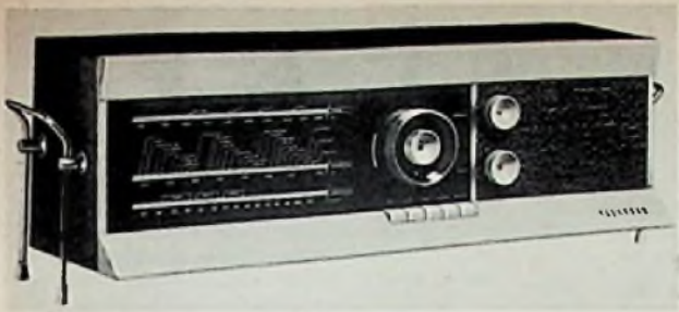
Bild 7 Versuche im neuen Stil (I): Ferguson „Futura“, ein vielbeachteter 6-Röhren-Empfänger mit UKW, MW und LW; Ferritantenne und Drucktastensatz
