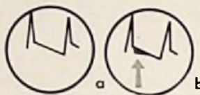
Impulse an der Anode der Bildkippen-Endröhre; a = richtiger Verlauf, b = fehlerhafter Verlauf mit Schwingerscheinung
