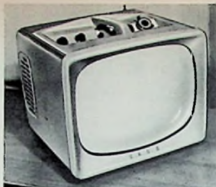
Bild 3. Transportabler Fernsehempfänger mit 36-cm-Bildröhre, versenkt auf der Oberseite angebrachten Bedienungsknopfen und Tragegriff (Ekco T 308)
