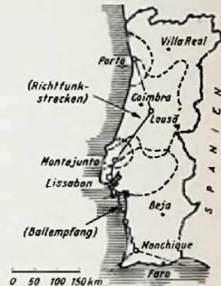
Bild 1. Standorte und Versorgungsgebiete der fünf portugiesischen Fernsehsender. Zwischen den Sendern Lissabon und Monchique besteht Ballempfang
