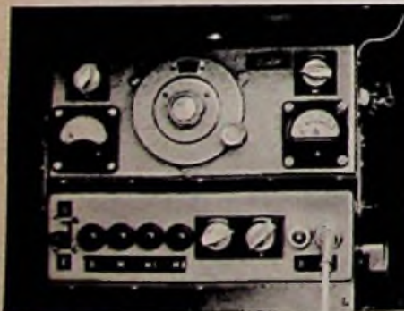
Bild 6. 80-m-Station unter dem Armaturenbrett. Der Autosuper dient als Empfänger, darunter der Sender und ganz unten der Modulationsverstärker
