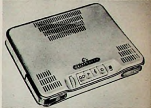
Bild 2. Telefunken-Zweikanalverstärker S 80, mit dem man auch einkanalige Rundfunkempfänger zur Stereo-Wiedergabeanlagen umgestalten kann, soweit ein Stereo-Plattenspieler und Außenlautsprecher vorhanden sind. Der Verstärker läßt sich auch einkanalig verwenden. Abmessungen: 310 × 230 × 60 mm
