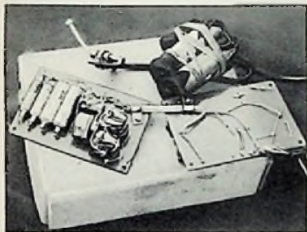
Bild 2. Baustufen des gemischt-bestückten Empfängers (DL 651/2 X GFT 21/OC 602) von Paschke. Das Gerät enthält ein Zungenrelais und zwei Nachfolge-Relais, die im Eigenbau hergestellt sind
