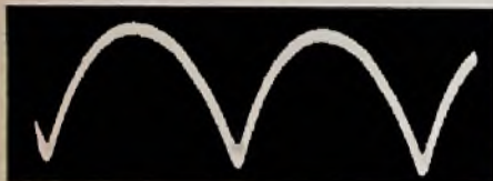
Bild 5. Parabel-Impulse an den Stabgliedern der Vertikal-Ablenk-Stufe. Sie dienen als Steuerimpulse für die Flip-Flop-Stufe (Bild 3); Impulsdauer: 20 µs
