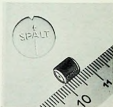
Bild 7. Die Peritrix-Endo-Radiozelle im Größenvergleich zu einer Tablette
