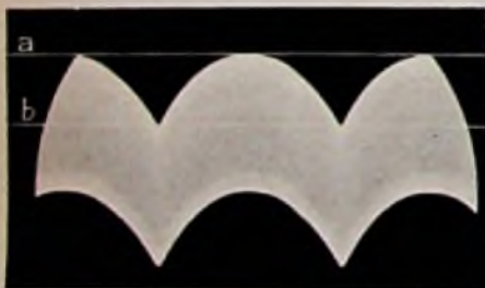
Bild 6. Am Steuergitter der Flip-Flop-Triode überlagerte Impulsform. Zwischen a und b liegt der Arbeitsbereich der verschiebbaren Schwellenspannung
