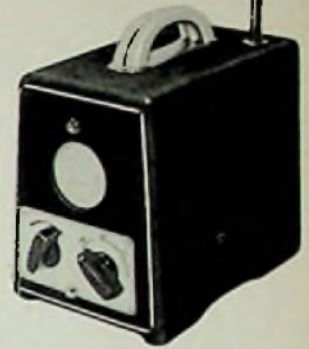
Bild 1. Transportabler Einkreiser mit Batterieröhren für unterwegs. Eine Teleskopantenne dient für Orts- und Bezirksenderempfang
