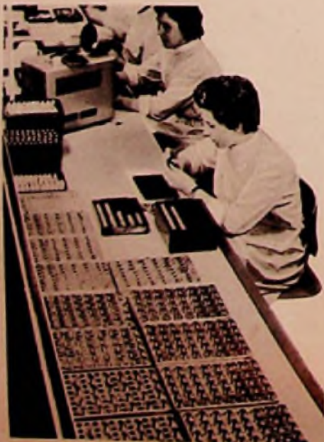
Endkontrolle und Codierung der Transistoren
