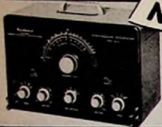
AG-10 Sinus-Recteckgenerator, 20 Hz - 1 MHz, Ausgangsp. 10 V Bausatz DM 449 - Fertiges Gerät DM 494.-
