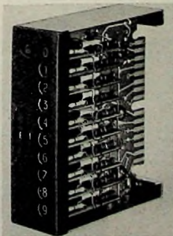
Bild 2. Dezimal-Zähleinheit von Valvo mit Kaltkathodenröhren und gedruckter Schaltung
