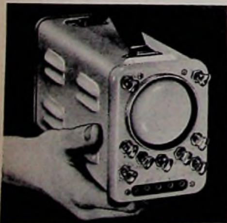
Bild 11. Klein-Oszillograf Modell 1039 M der britischen Firma Cossor
