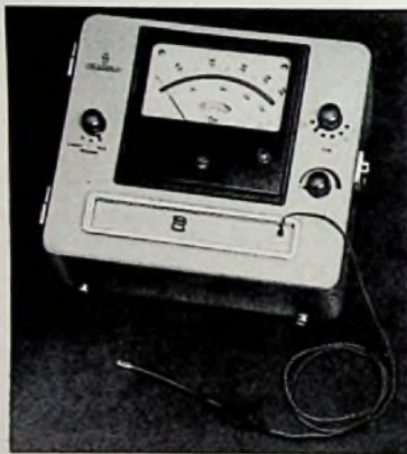
Bild 6. Magnetfeldmeßgerät mit Hallsonde von Siemens & Halske
