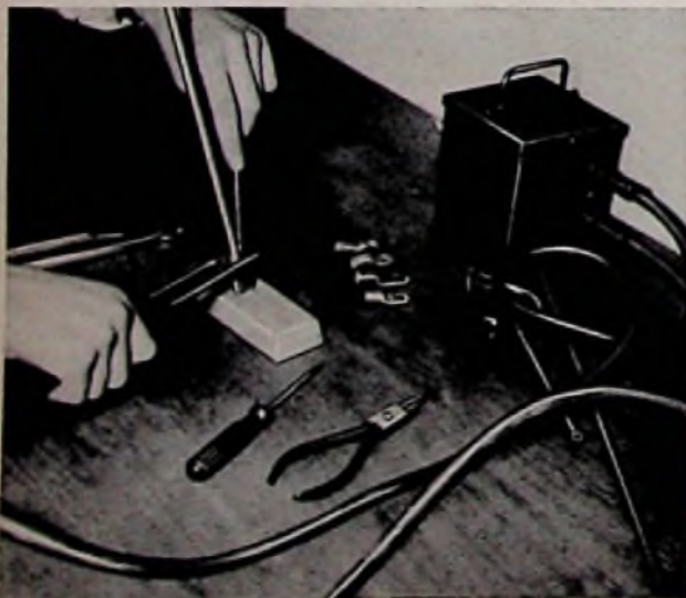
Bild 2. Handhabung der Lötzange
