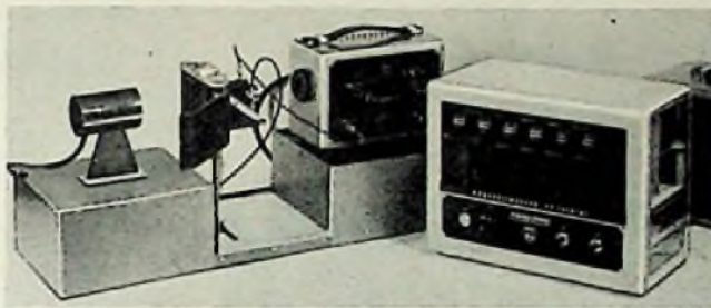
Bild 1. Verschußzeit-Meßgerät, aufgebaut mit Valvo-Dezimal-Zähleinheiten, bestückt mit der Zählröhre E 1 T
