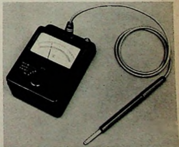
Bild 3. Das handliche Temperaturmeßgerät Thermizet von Siemens & Halske
