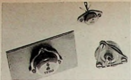
Bild 2. Siemens-Leistungstransistoren TF 77 (oben) und TF 80 (unten) mit Befestigungselementen
