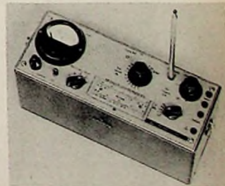
Bild 3. Das neue Transistor-Betriebsstrommeßgerät von Siemens & Halske
