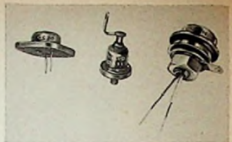
Bild 3. Leistungstransistoren OC 30 und OC 18 der Valvo GmbH; in der Mitte die Leistungsdiode OA 31
