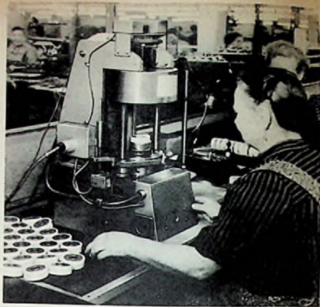
Bild 7. Magnetisieren der fertig montierten keramischen Magnetsysteme
