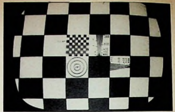
Bild 13. Korrektes Bild. Eine Richtantenne ist über ein 10-dB-Dämpfungsglied an das Antennenkabel angeschlossen; es erzwingt m_A = 1 und m_E = 1
