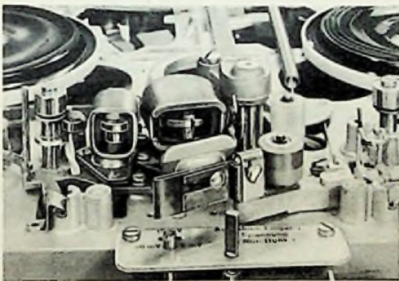
Bild 4. Die drei Tonköpfe des KL 35; von links nach rechts: Löschkopf, Sprechkopf, Hörkopf
