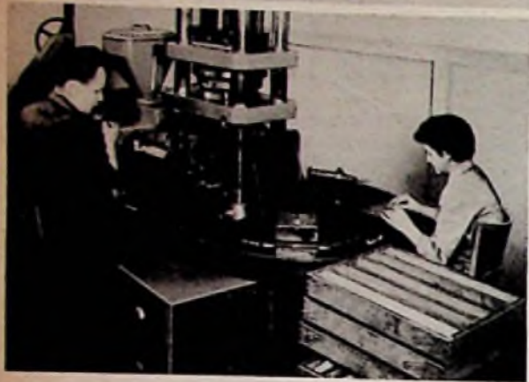
Bild 6. Das Umspritzen der Magnetsysteme mit Polyamid
