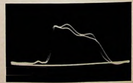
Bild 24. Wie Bild 23, jedoch Tuner ohne Dämpfungsglied direkt an die Antennenzuleitung angeschlossen
