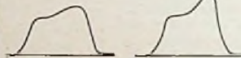
Bild 16. Hf-Durchlaßkurve des Tuners (Ursache der Unsymmetrie: Kabel zwischen Antennenbuchsen und Tuner ist einseitig kapazitiv belastet, indem es auf einer Länge von 25 cm verkantet am Chassis entlangführt)
