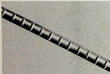
Bild 1a. Gitterholm mit eingeschnittenen Kerben (vergrößert)
