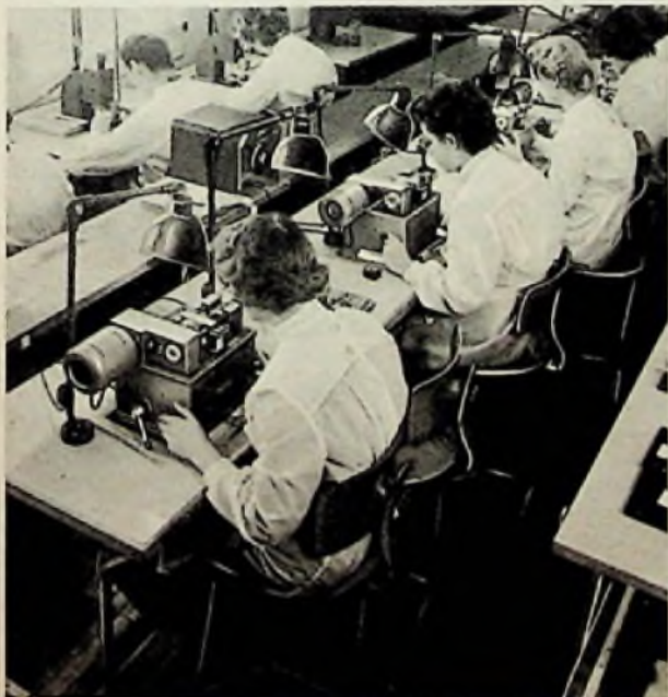
Bild 5. Das Bewickeln der Rahmenstränge mit dem sehr dünnen Gitterdraht erfolgt auf besonderen kleinen Maschinen
