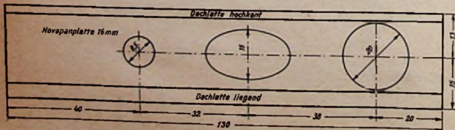
Bild 2. Maße der Schallwand (Maße in cm)
