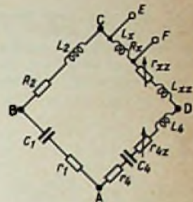
Bild 5. Einfluß von Fehlwinkeln in den Normalzweigen einer Owen-Brücke. Die Fehlwinkel sind umso störender, je phasenreiner das Meßobjekt und je höher die Meßfrequenz ist
