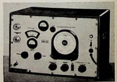
Interessant an diesem Frequenzmesser Rel 3 F 113 für 950 bis 5000 MHz ist, daß die Grundfrequenz mit einem Topfkreis für 95 bis 105 MHz erzeugt wird. Sie liegt also etwa im UKW-Rundfunkbereich
