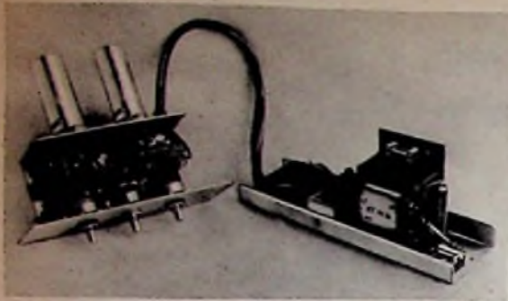
Links: Bild 4. Die beiden U-Bleche mit dem Entzerrer (links) und dem Netzteil (rechts)
