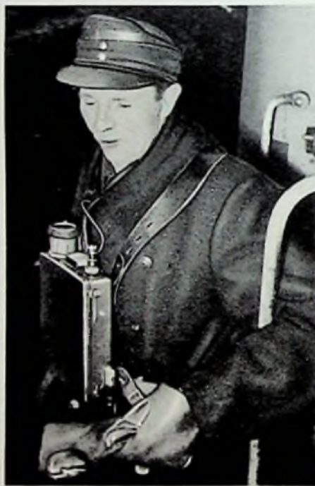
Oben: Bild 2. Das Teleport IV im Rangelbetrieb. Das Stromversorgungsgerät wird auf dem Rücken getragen
