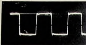
Bild 14. Rechteckfrequenz von 100 kHz am Ausgang eines Video-Verstärkers
