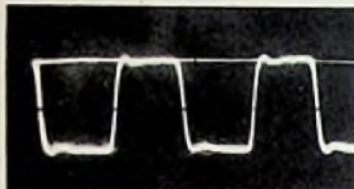
Bild 15. Rechteckfrequenz von 400 kHz am Ausgang eines Video-Verstärkers
