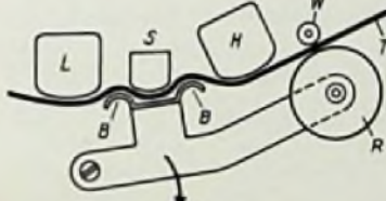
Bild 4. Arbeitsweise von Andruckrolle und Bandanlegebügel
