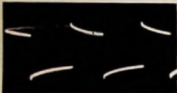
Bild 12. Dachschräge einer 50-Hz-Rechteckfrequenz bei einem Video-Verstärker
