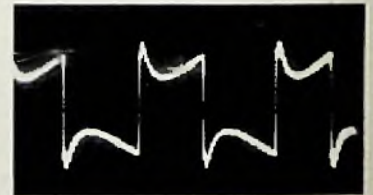
Bild 6. Rechteckfrequenz von 800 Hz bei voller Tiefen- und Höhenanhebung
