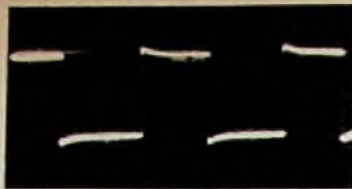
Bild 13. Rechteckfrequenz von 1 kHz am Ausgang eines Video-Verstärkers
