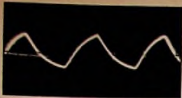
Bild 9. Rechteckgrundfrequenz von 3 kHz mit Höhenbescheidung
