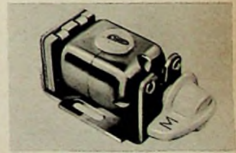
Das Vierpol-Magnet-Abtastsystem von Perpetuum-Ebner für höchste Wiedergabequalität. Die Ausgangsspannung ist für ein Magnetsystem sehr hoch, so daß der Entzerrungsverstärker wenig Aufwand erfordert
