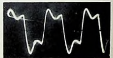
Bild 5. Oszillogramm einer Rechteckfrequenz von 30 kHz
