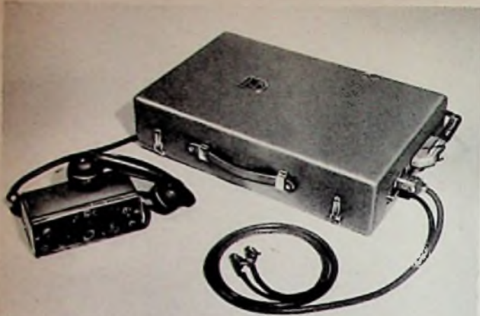
Bild 4. Ein 15-Watt-Gerät der Baureihe 300 mit Handhörer und Spezialzusatz zum Anschluß von Meßgeräten für die geologische Forschung
