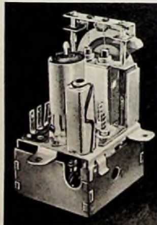
Bild 2. Oberteil der Abstimmereinheit. Vorn der Zf-Kreis, dahinter die Röhre ECC 85 im Abschirmbecher und der Abstimmstift mit dem Eisenkernfahrstuhl
