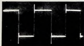
Bild 1. Ausgangsspannung des Nf-Verstärkers für eine 1-kHz-Rechteckschwingung
