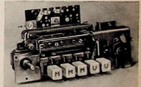
Bild 3. Dieses Bild zeigt die robuste Ausführung des Drucktastensatzes im Telefunken-Autoempfänger II D 61 (II D 11). Darüber ist die Umschaltplatte für 6- oder 12-Volt-Betrieb sichtbar
