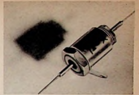
Bild 1. Telefunken 1-W-Leistungstransistor Typ OD 604
