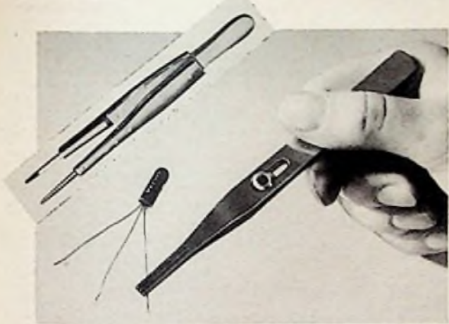
Oben links: Wiesola-Isolierpinzette; rechts: Wärmeableitpinzette mit dreiteiligen Backen von Funke
