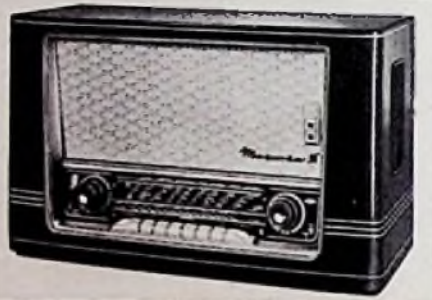
Bild 2. Das Multiphon-Register im Nora-Mazurka 56 5 L ist rechts in der Lautsprecheröffnung untergebracht
