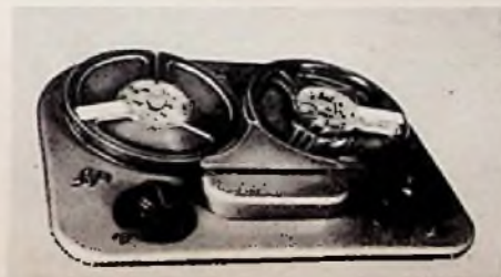
Bild 2. Chassis des Saja-Tonbandgerätes
