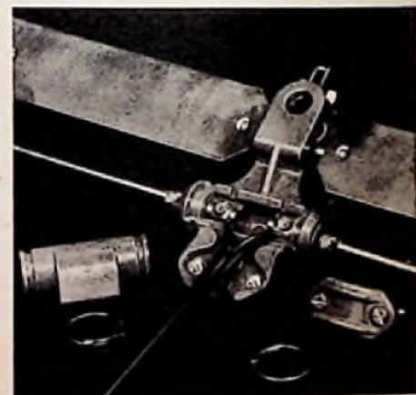
Bild 4. Anschlußstück der Siemens-Kanalantenne mit Anpaßblechen
