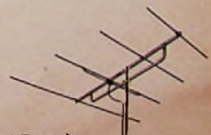
Bild 1. 4-Element-Fernsehantenne FSA 231 von Fuba mit Parallelstütze am Tragrohr
