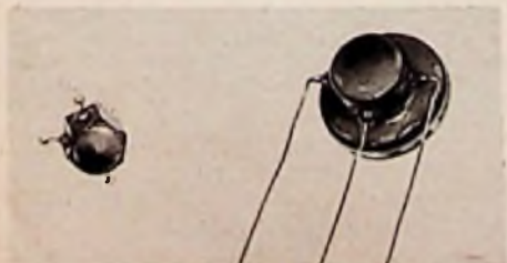
Bild 3. Die neuen Siemens-Transistoren TF 75 (250 mW) links und TF 85 (1 W) rechts
