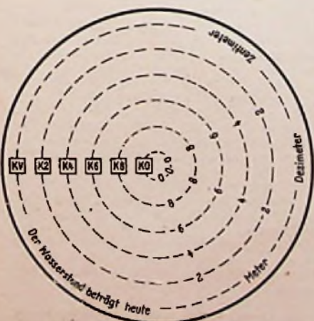
Bild 3. Prinzip der Meßwertübertragung mit gesprochenen Zahlen nach dem Assman-Verfahren. Von den elf Tonspuren sind zur Vereinfachung nur sechs gezeichnet
