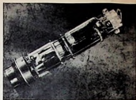
Bild 1. Eine eigens entwickelte Mikrofonverstärkeröhre, den Verstärker selbst und einen Übertrager enthält das kleine Kondensatormikrofon von Hiller
