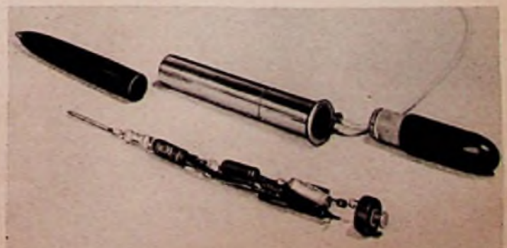
Bild 4. Bauteile des Prüfmultivibrators vor dem Zusammen-setzen
