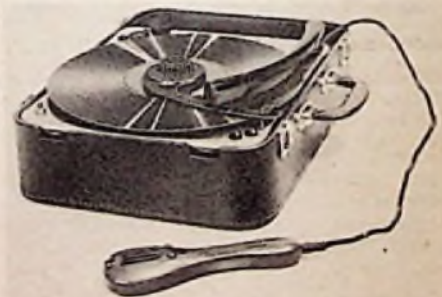
Dimafon Modell 1955; vorn das Handmikrofon mit den beiden Bedienungstasten
