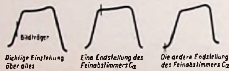
Bild 63. Wirkungsweise der Oszillator-Feinabstimmung bei Metz
