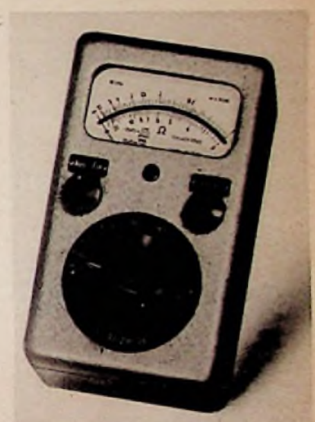
Bild 1. Scheinwiderstandsmesser ZT 800/1. Hersteller: Oskar Vierlinger, Ebermannstadt
