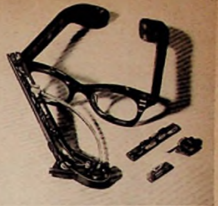
Die Hörbrille und ihr Aufbau. Mikrofon, Verstärker und Hörer befinden sich im Brillengestell
