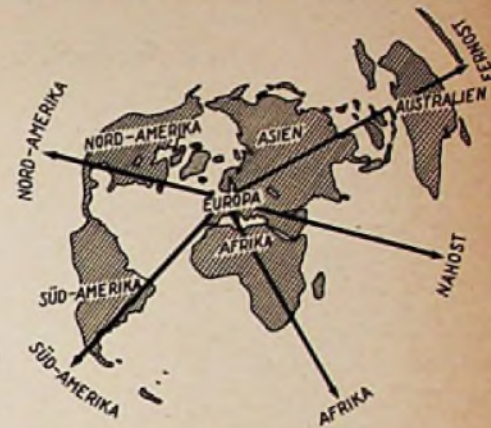
Bild 1. Hauptstrahlrichtungen der Groß-Senderanlage „Deutsche Welle“
