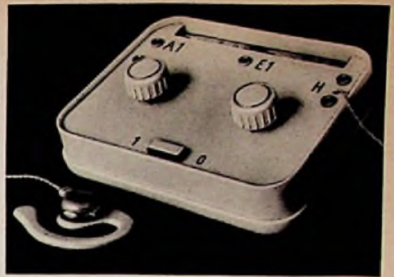
Bild 1. Transistor-Empfänger E 551. An der Oberkante erkennt man die beiden Batterien, links die Antennenbuchsen, rechts die Kopfhörerschnur und zwei zusätzliche Hörerbuchsen, in der Mitte die beiden Drehknöpfe für die Abstimmkondensatoren und vorn den Griff für einen Schiebeschalter
