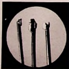
Mikroaufnahme zerfressener Kupferlackdrähte
