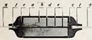
Bild 1. Schnitt durch einen Wima-Tropydur-Kondensator
