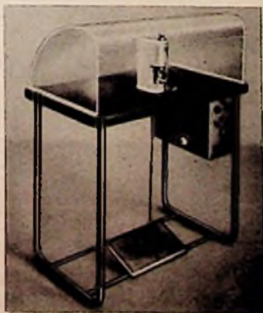
Bild 1. Neue vollelektronische Präzisions-Punktstschweißmaschine mit durchsichtiger Staubschutzhaube
