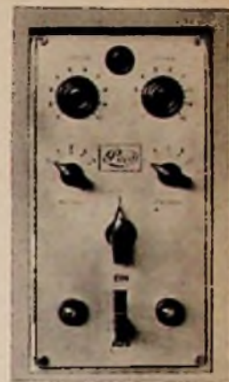
Bild 2. Frontplatte des Steuergerätes der neuen Peco-Findepunktstschweißmaschine
