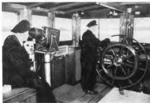
Telefunken-Decca-Radargerät für Binnenschiffe; Sichtgerät im Steuerhaus
