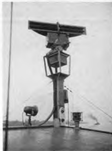
Antenne des Binnenschiffs-Radargeräts von Telefunken/Decca an Deck des Versuchsschiffes Mainz
