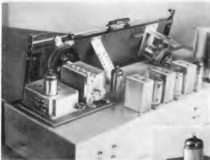
Bild 2. Fertigt montiertes Chassis. Links der UKW-Eingangsteil und daneben der Abstimmkondensator
