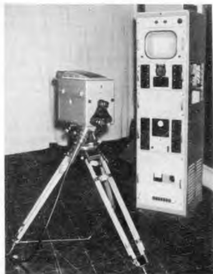
Die Philips-Fernsehkamera und Bedienungsanlage mit Speisegerät, Videoverstärker und Kontroll-Bildröhre
