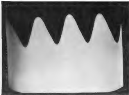
Bild 5. Oszillogramm einer Sinusspannung vom Schirm einer 36-cm-Bildröhre aufgenommen
