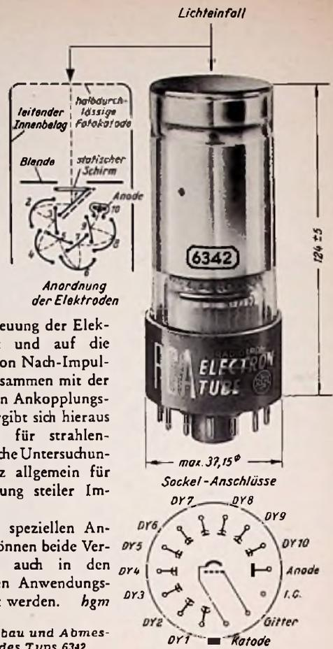
Bild 2. Aufbau und Abmessungen des Typs 6342
