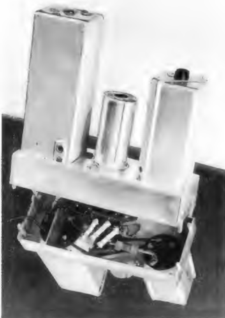
Bild 2. Baustein für den zweiten Überlagerer; auch hier ist die Unterseite im Spiegel zu erkennen
