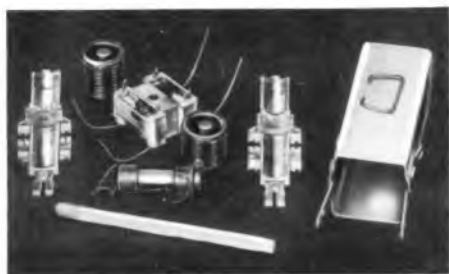
Bild 6. Neue Miniaturbandfilter im „Exporter“ mit Glockenkernen
