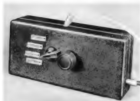
Bild 1. Handliche Ausführung des Prüfgenerators für vier feste Zwischenfrequenzen
