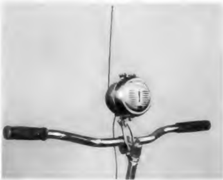
Bild 1. Der Empfänger Faras (Powerphon 110) ist in ein scheinwerferähnliches Gehäuse eingebaut. An der Vorderseite aus Preßstoff die Schall-Austrittsöffnungen und zwei Fenster für die Skala und den „Magischen Strich“; auf dem Gehäuse links der Lautstärkenregler, rechts die Senderabstimmung
