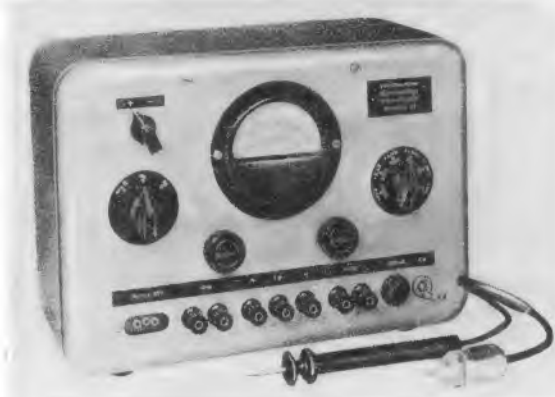
Bild 1. Der VOS, eine Kombination von Voltmeter, Ohmmeter und Signalverfolger, mit Tastköpfen für Hochspannung (schwarz) und Hochfrequenz (weiß). (Kimmel GmbH, München)
