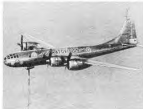
Eine umgebaute B-29 mit eingebautem Fernsehsender und ausgefahrener Antenne auf einem Versuchsflug
