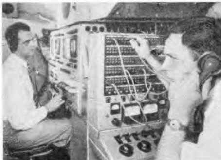
Blick in das Innere des Stratovision-Flugzeugs: zwei Ingenieure am Ballempfänger und Schaltpult
