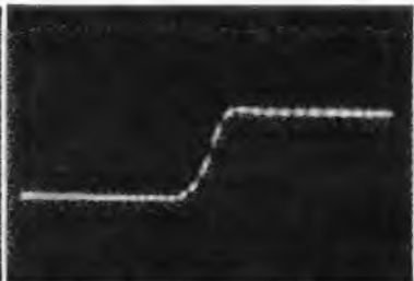
Bild 8. Oszillogramm der Vorderflanke des empfangenen Meßimpulses im Kurzschlußbetrieb d. h. ohne Zwischenschaltung einer zu prüfenden Strecke
