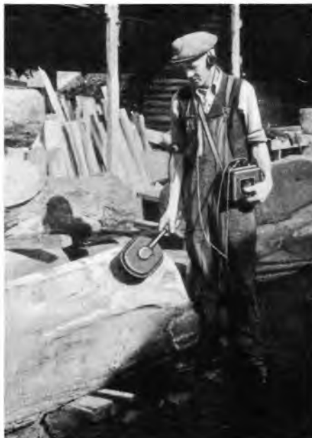
Metallsucher zum Aufspüren von Metallteilen in Baumstämmen, ehe sie dem Sägewerk zugeführt werden
