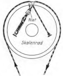
Zum leichten Auflegen eines Skalenseiles wird die Spannfeder nicht mit dem Seil verknötet, sondern in eine Schlaufe eingehängt, die mit Hilfe eines Hohlriets gebildet wird. Durch Zusammendrücken des Riets läßt sich die Schlaufe festlegen, nachdem die richtige Seillänge eingestellt worden ist
