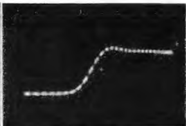
Bild 9. Oszillogramm der Vorderflanke eines über eine Teilstrecke der Fernsehrichtverbindung gesandten Meßimpulses. Das Überschwingen v. ca. 5% ist bereits deutlich sichtbar
