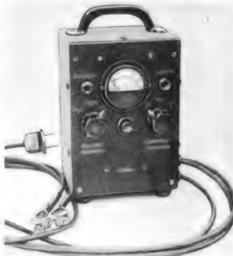
Bild 4. Vorderansicht des Ladegleichrichters G 620 a
