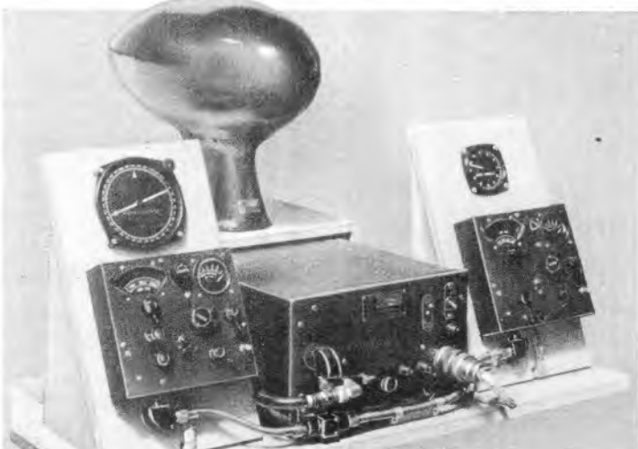
Radokompaß SCR 269. Auto- matische Peilanlage für Flugzeuge zur Peilung von Rund- funksendern (200 ... 1700 kHz), Funktechnische Werke GmbH.
