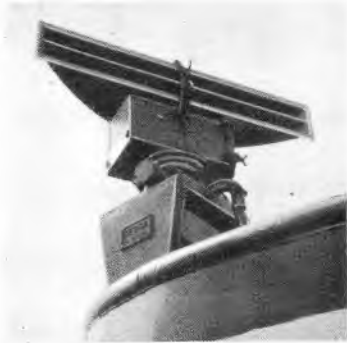
Radar-Antenne an Bord eines Handelschiffes. Das Oberteil dreht sich ständig und tastet die Umgebung mit Zentimeterwellen ab (Aufn.: Telef.)
