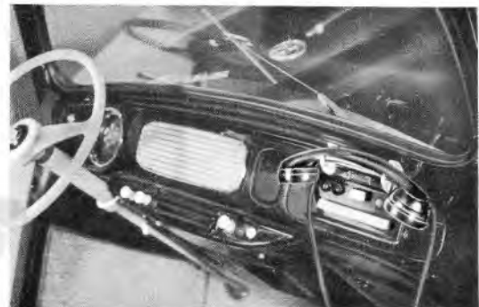
Volkswagen mit einem Funksprechgerät für den öffentlichen beweglichen Landfunkdienst der Bundespost. Von diesem betriebsfähigen Gerät wurden Funkgespräche in das öffentliche Fernsprechnetz vermittelt
