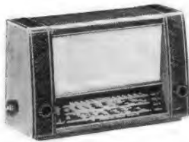
SPEZIALSUPER 54 8 Röhren · 6 AM-/9 FM-Kreise
