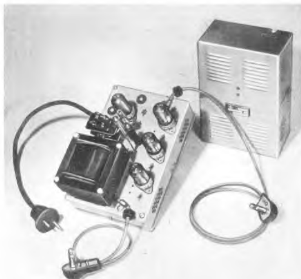
Telo-Fernseh-Antennenverstärker für Gemeinschaftsanlagen
