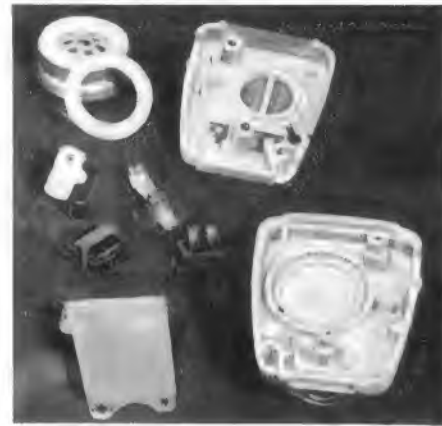
Bild 2. Mikrofon MD 5 mit Schalter und Übertrager in zerlegtem Zustand. Man erkennt folgende Einbauteile: Die Mikrofonkapsel, zwei Auflagerungselemente zur elastischen Lagerung der Kapsel, die Schaltwippe mit eingesetzter Achse, den fertig zusammengebauten Federatz des Sprechschalters, des Anpassungsübertragers, die Verkleidungsgaze für die Sprechöffnung und die beiden Gehäusehälften
