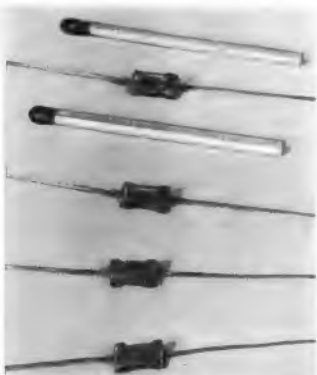
Größenvergleich neuerzeitlicher Glimmerkondensatoren (Josef Pech KG)
