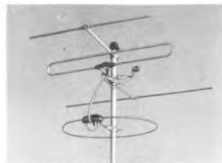
Hirschmann-Fernsehantenne mit UKW-Ringdipol kombiniert
