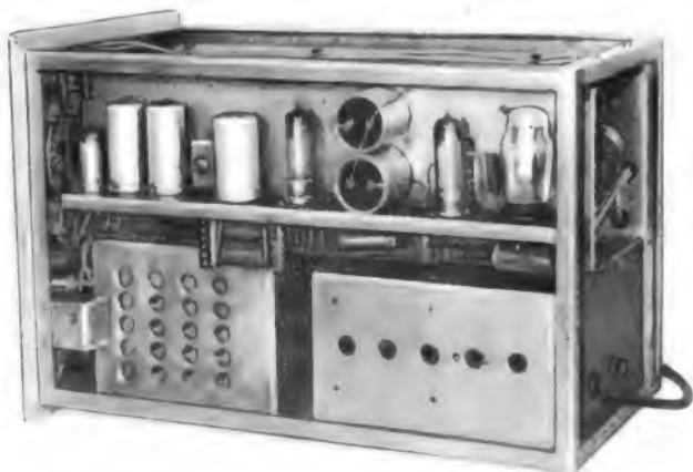
Bild 3. Innenansicht mit den Abschirmgehäusen für die Generatoren
