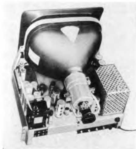
Chassis des Nord-Mende-Fernsehgerätes Panorama
