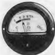
Entladeanzeiger für Akkumulatoren (AFA)
