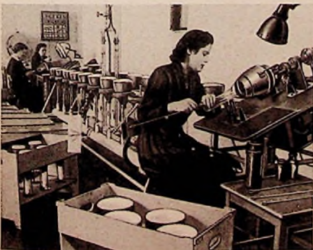
Bild 5. Aufbringen des leitenden Innenbelages (Schwärzung) im Kolben von Oszillografenröhren
