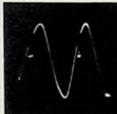
Bild 172. Oszillogramm an der Anode des Netz-Steuerge- nerators. Der Sinus- spannung ist der dazu synchron laufende Raster- impuls überlagert
