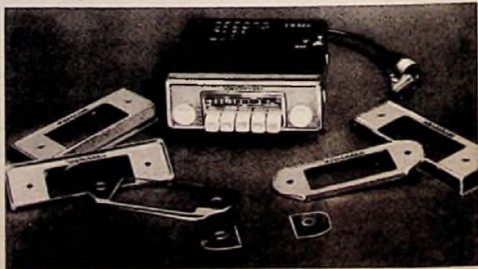
Bild 8a. Das Empfangsgerät des Telefunken-Autosuper ID 53 A paßt mit Hilfe verschiedener Ziermasken in alle gängigen Wagentypen
