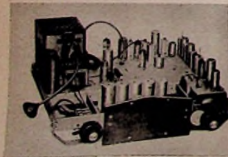
Bild 2. Chassis-Ansicht des Grundig-Fernseh-Tischempfängers Type 210
