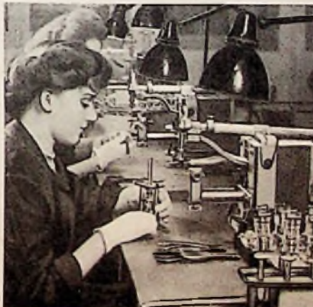
Bild 3. System-Montage der Oszillografenröhrenfertigung (Bilder aus der Telefunken-Fertigung)
