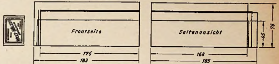
Bild 1. Abmessungen der Empfangsteile von Autosupern vier verschiedener Firmen (Links als Größenvergleich eine Zündholzschachtel)
