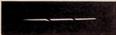
Bild 169. Oszillogramm des Gitterspannungsverlaufs am zweiten Multivibratorgitter; dieses Gitter ist während der Impulsperiode nur kurzzeitig verriegelt
