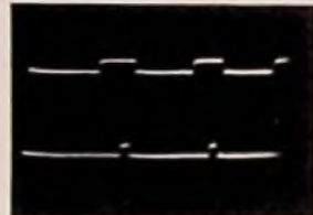
Oberes Bild: Die Zeitkonstanten der Gitterkreise sind nur wenig voneinander verschieden. Unteres Bild: Die Zeitkonstanten unterscheiden sich wesentlich stärker voneinander
