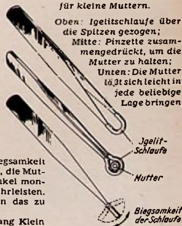
Pinzette als Haltevorrichtung für kleine Muttern.
