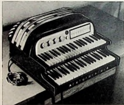
Bild 1. Hohner-Multimonica, ein kombiniertes Musikinstrument für Winddruck- und elektronische Tonerzeugung (Aufnahme: Photo-Jörg, Trossingen)
