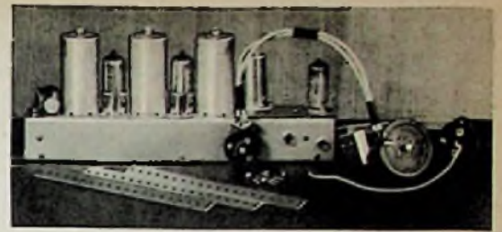
Bild 1. Ansicht des UKW-Super-Einbaugerätes. Der kleine Metallzylinder rechts neben dem Bandfiltertopf dient zur Abschirmung der Oszillatorröhre
