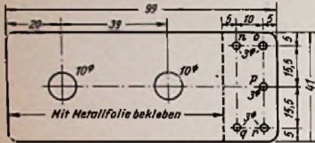
Bild 5. Frontplatte (Sperrholz 6 mm); n, o fur Anschlu des 1. Horers; p fur Antennenanschlu; q, r fur Anschlu des 2. Horers, Lochdurchmesser = 3 mm
