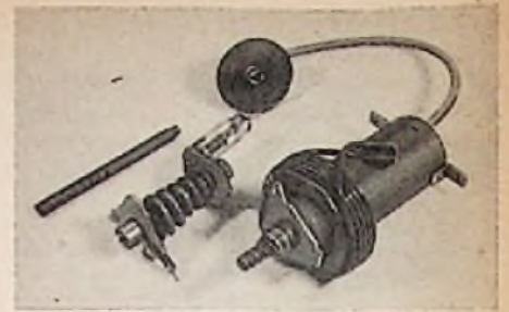
Bild 6. Vollständiger Horizontalübertrager entsprechend der neuen Schaltung. Die Zusatzspule ist auf ein Hartpapierrohr gewickelt und wird von der Heizwicklung für die Hochspannungs-Gleichrichterröhre umgeben. Im Innern befindet sich die links daneben abgebildete Hochspannungsspule mit der Hochspannungs-Gleichrichterröhre. Der verschlebbare Ferritstab gestattet eine Veränderung der Bildbreite
