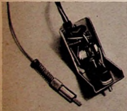
Bild 2. Verdrahtungsansicht. Unterhalb der Abschirmbuchse ist der Klein-Elektrolytkondensator (8 \mu F) zu sehen
