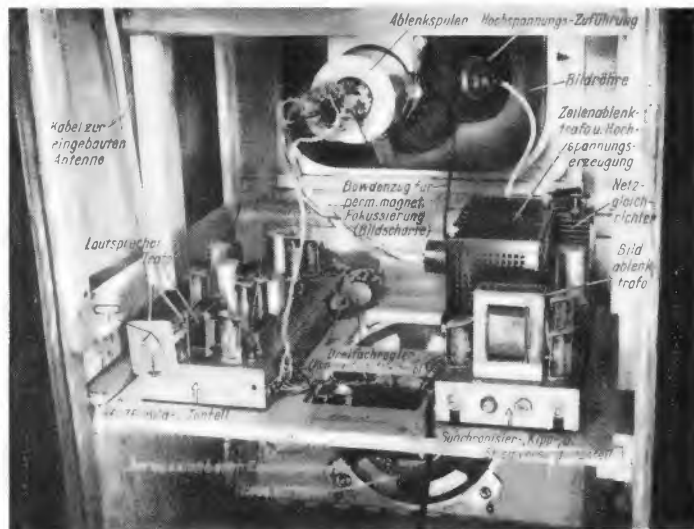
Links: Innenansicht des „Lumen“. In der Mitte der ausziehbare Zwischenboden mit den beiden Chassis, darüber die von einer Quertraverse getragene Rechteck-Bildröhre mit der Ablenk-einheit und der Anschluß-Fassung Aufnahme: Schwahn
